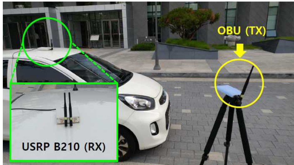
그림 101. USRP B210와 OBU로 구성된 테스트 베드
