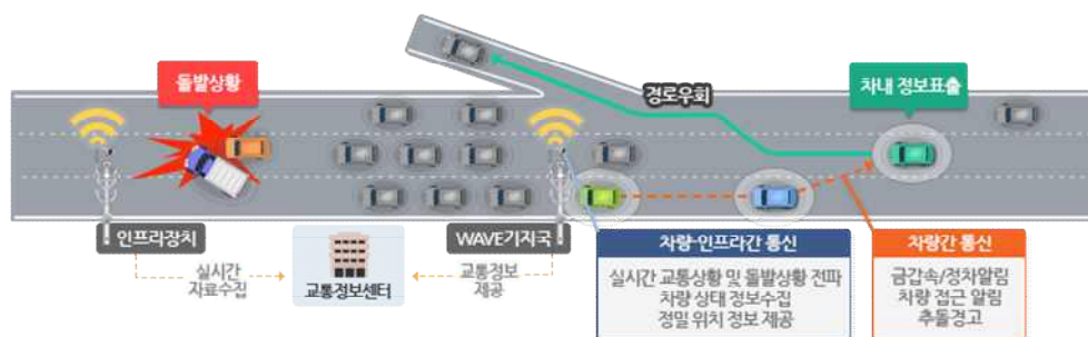
그림 3. C-ITS 사업에서 추진 중인 V2X 통신 용 고속도로 인프라 구축 예시
