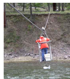
재래식 부유사 채집기 및 직접 현장 측정 방식
