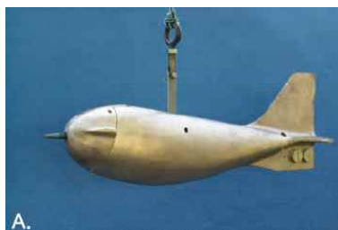
재래식 부유사 채집기 및 직접 현장 측정 방식
