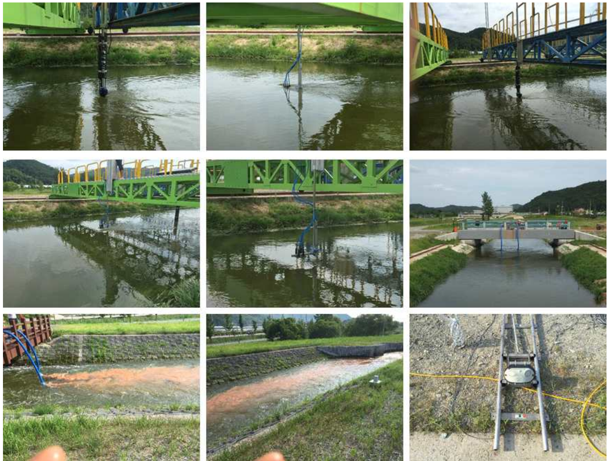
유사 공급 및 유사 측정 장비
