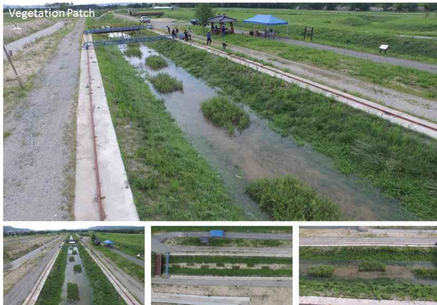
현재 수행중인 실규모 하천 실험 (하도 변화 분석)
