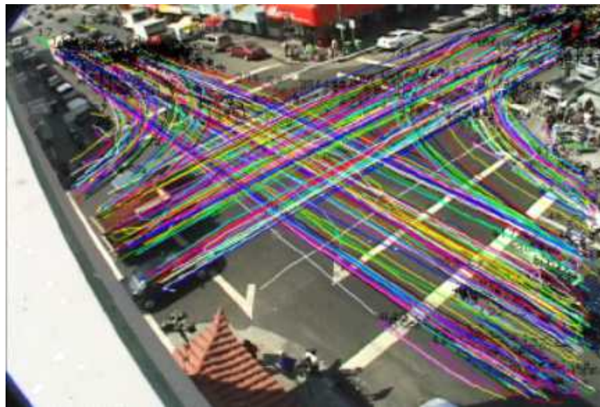
[그림 66] 영상처리를 통한 차량궤적 인식 (예시)
