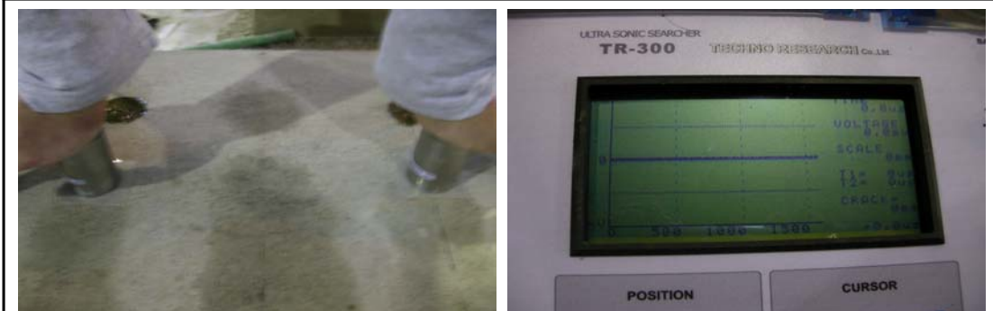
콘크리트 모형 시험체, TR300, 박판 2 (투명실리콘) : 수신불능
