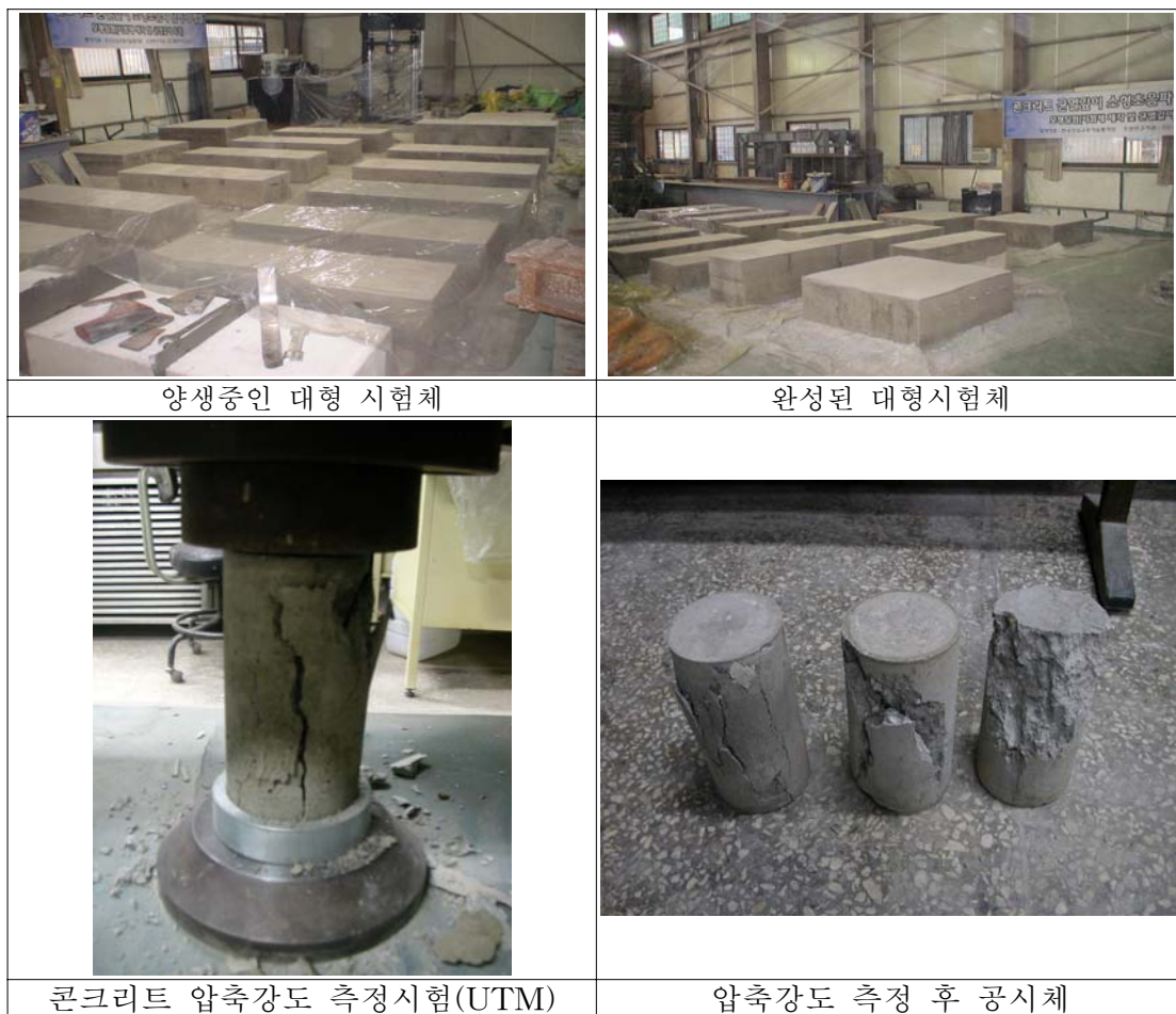
사진 3.1.2.2 완성된 대형시험체와 압축강도 시험
