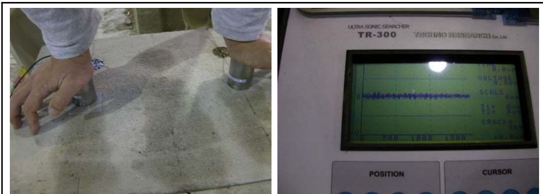
콘크리트 모형 시험체, TR300, 박판 3 (성형실리콘) : 수신불능
