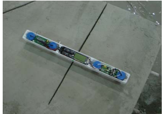
배근 시험체 균열깊이 65mm, 평행 교차 (압축강도 21Mpa)
