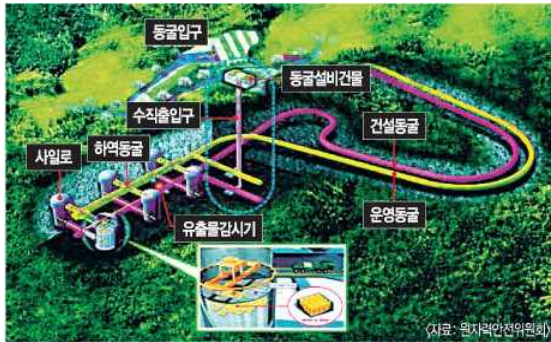
<그림 1.6> 중·저준위 방사성 폐기물 처분장 및 폐기물 보관용 콘크리트 사일로
