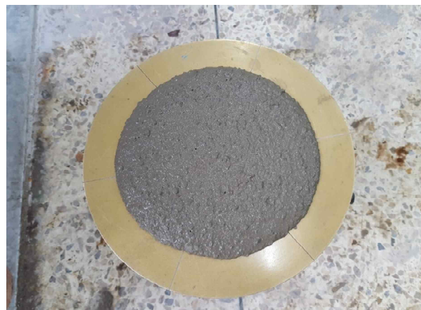
<그림 3.67> 플로우 실험 전경
