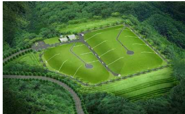
<그림 5.1> 표층 처분 시설 모식도 (출처: 한국원자력환경공단)
