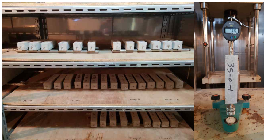
<그림 3.79> 길이변화 측정 전경
