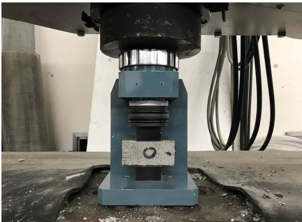
<그림 3.69> 압축강도 실험 전경
