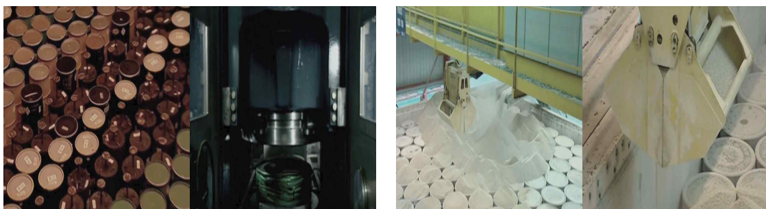
<그림 1.7> 중·저준위 방사성 고체 폐기물의 처분 과정
