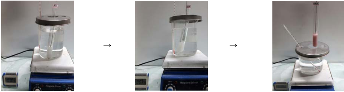
그림 81. 저점도 우레탄 화합물의 Gel Time 측정 전경
