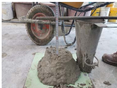
그림 89. 콘크리트 슬럼프 시험 전경
