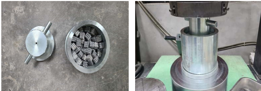
그림 88. 굵은골재의 파쇄시험 전경
