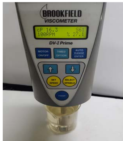
그림 80. Brookfield Viscometer LV를 활용한 점도 측정 전경
