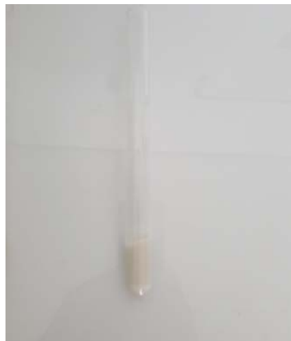
그림 84. 저점도 우레탄 화합물의 겔 타임 측정 시편
