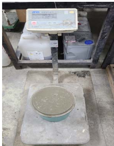
그림 91. 콘크리트의 단위 용적 질량 시험 전경
