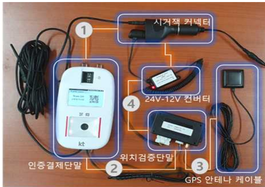
〈그림 2-나-28〉 MaaS 스마트 디바이스와 위치검증단말기의 배선도
