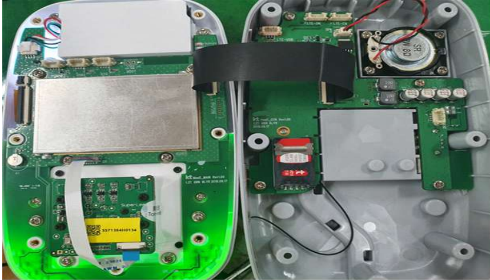
〈그림 2-나-25〉 MaaS 스마트 디바이스의 단말기 내부 (좌:전면, 우:후면)
