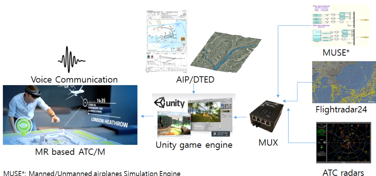
그림 1. MR 기반 관제체계 개념설계 검증을 위한 시범시제 구성도
