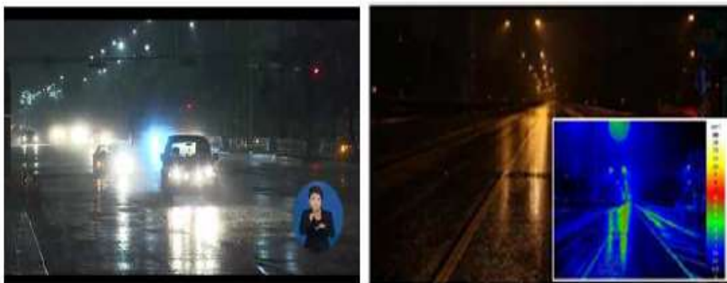
[그림 1-6] 야간/우천시 시인성 저하 및 도로조명 의한 차선 난반사 사례
