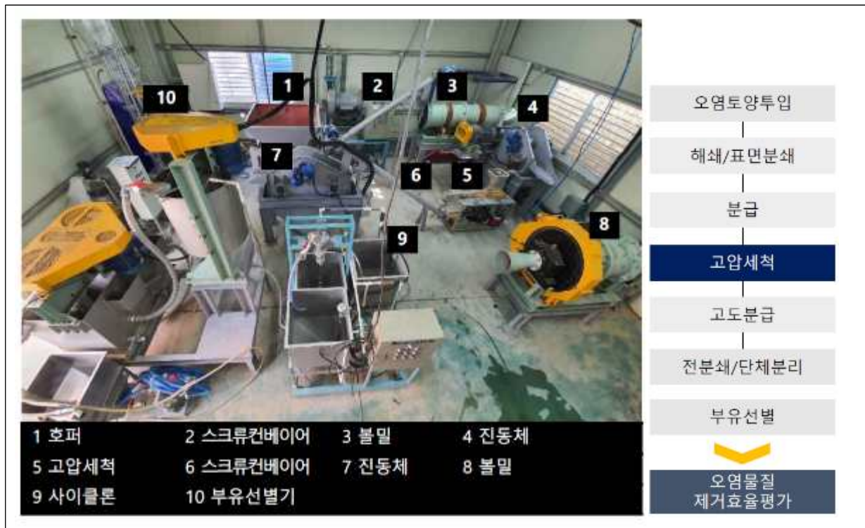
<그림 4-2> 국내 단독/연속공정 시험 설비(설치지역: 조선대학교)
