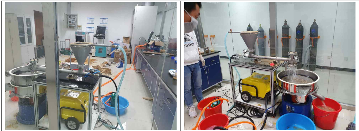
<그림 4-3> 중국 표면분쇄(고압세척) 시험 설비(설치지역: 중국과학원 북경연구센터)
