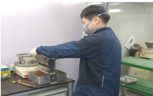
Riffle Splitter를 이용한 축분
