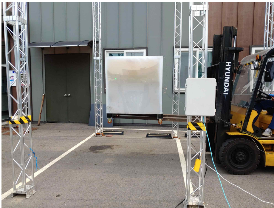
Fig. 3.4.18 화재 발화위치추적 자동소화시스템 1M 높이 발열원 추적
