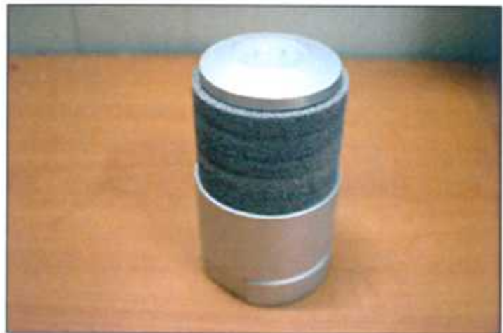
Fig. 3.2.32 K-Type 저소음 노즐 도면 및 사진
