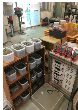
(b) ECE 시편 연결 및 방식 전류 인가 사진 <그림 3.2.X> ECE 모식도 및 방식 전류 인가
