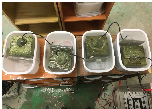
(b) ECE 시편 연결 및 방식 전류 인가 사진 <그림 3.2.X> ECE 모식도 및 방식 전류 인가
