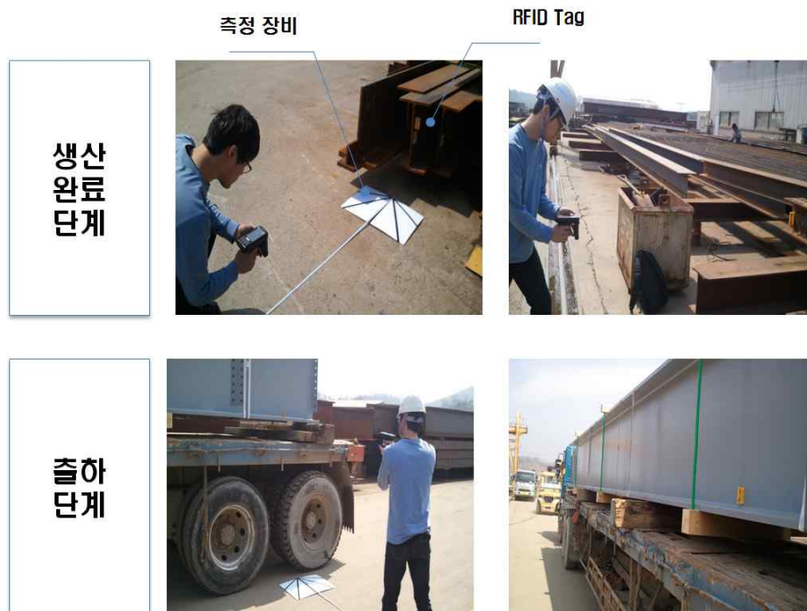
<그림 3-94> 철골 공장에서의 인식 테스트 모습
