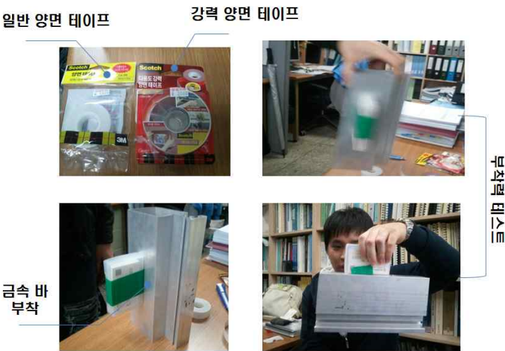
<그림 3-14> 스티커 타입의 부착력 테스트
