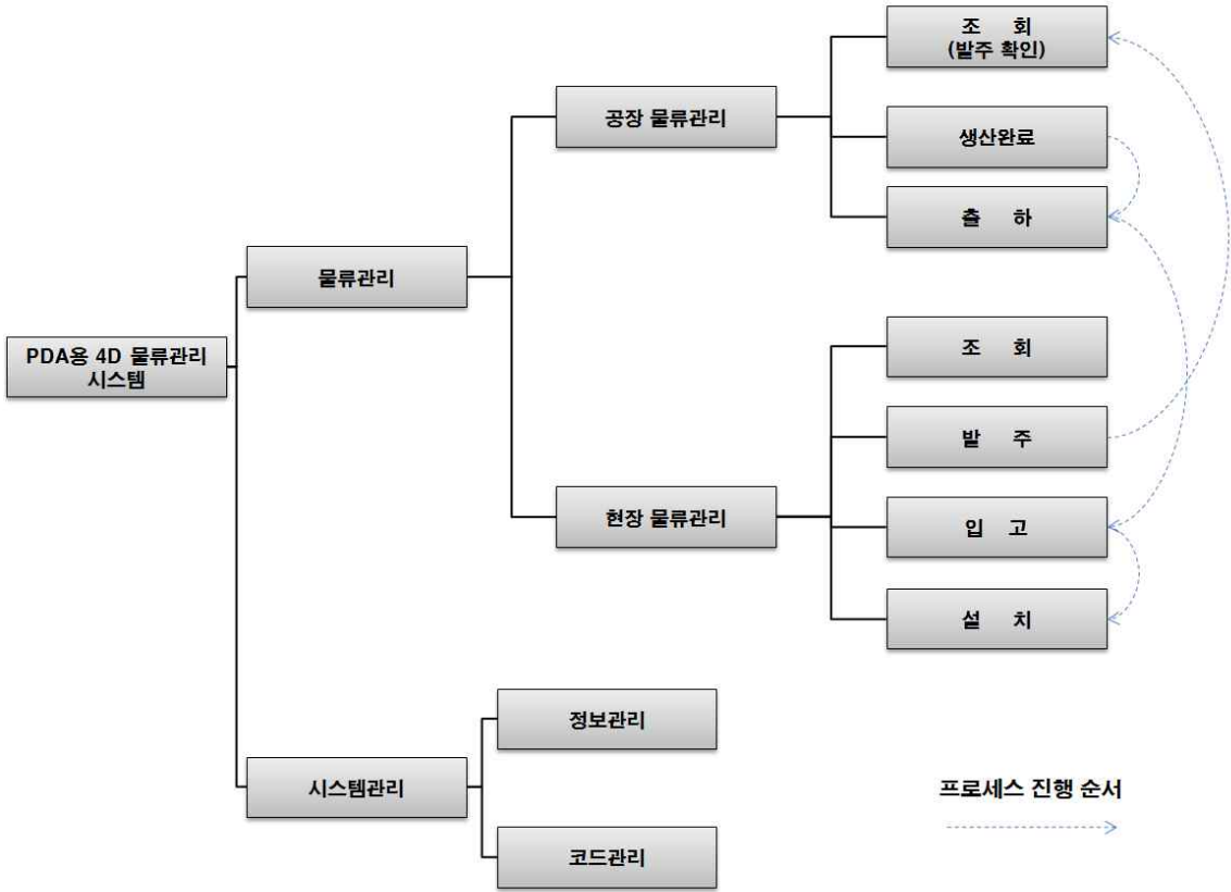
<그림 3-33> Reader(PDA) 모듈의 기능 정의
