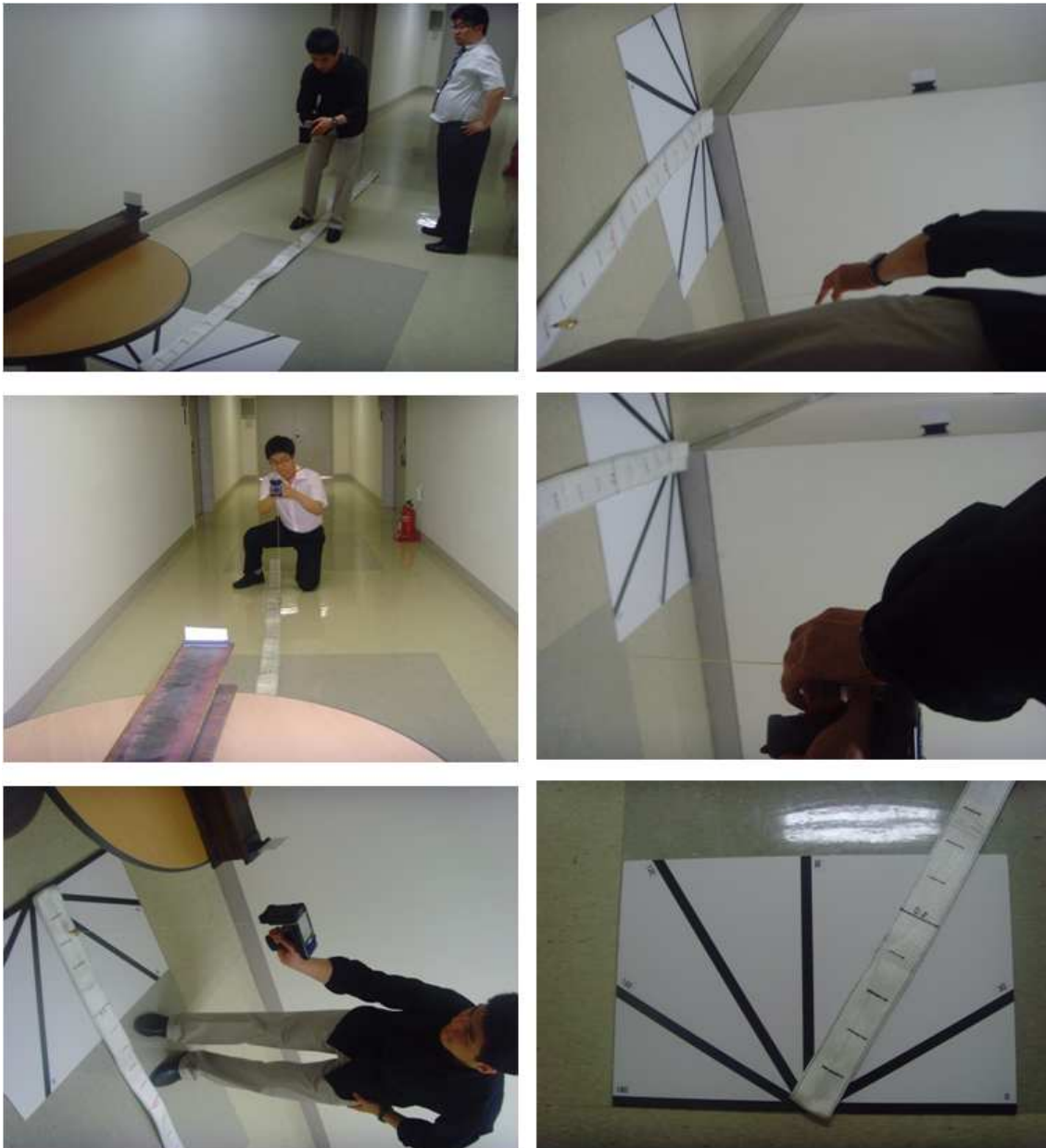
<그림 3-22> Tag 부착 장치의 인식 거리 테스트 모습
