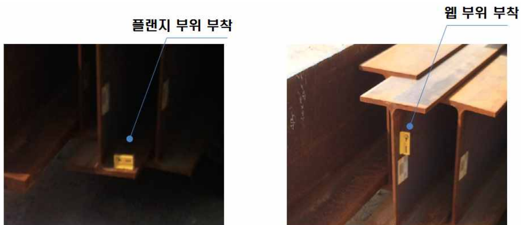
<그림 3-93> 철골 공장 및 현장 테스트를 위한 RFID tag 부착 위치
