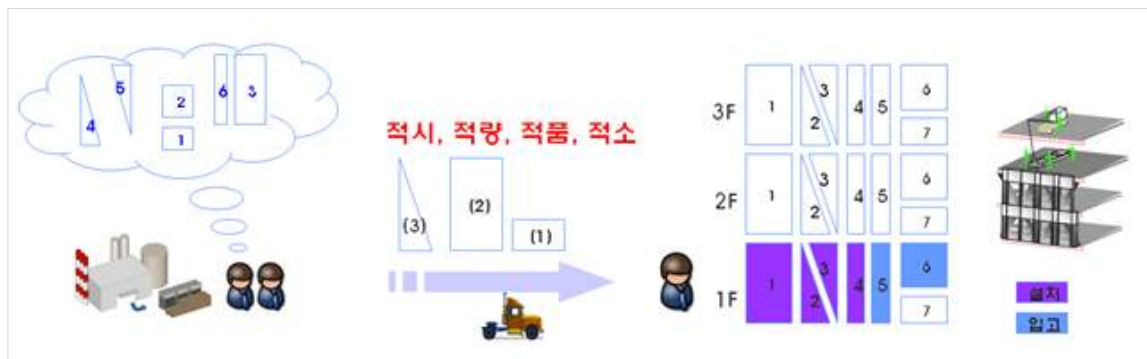
<그림 1-1> 건설 시공 단계에서의 Supply Chain 관리의 필요성 (커튼월 공사 예)
