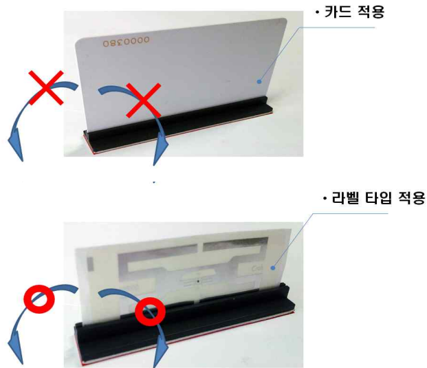
<그림 3-18> 라벨 타입 Tag를 위한 부착 장치 시작품
