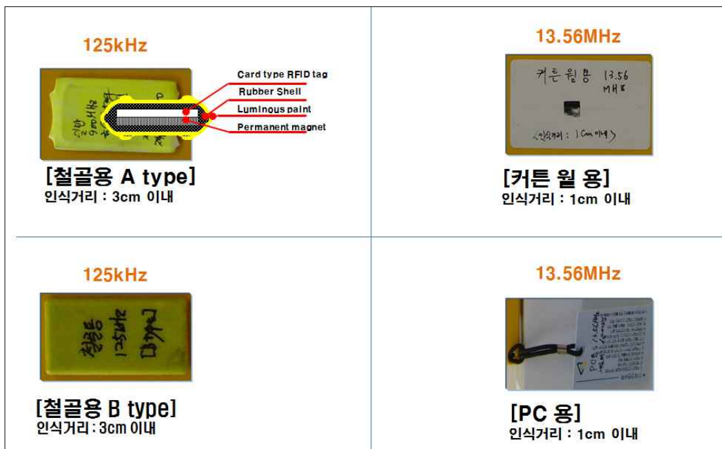
<그림 3-3> 업그레이드 이전 RFID+4D에 적용된 RFID Tag
