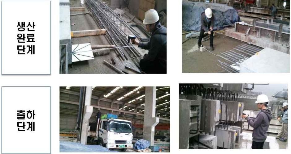
<그림 3-97> 스티커 타입의 공장 테스트 모습
