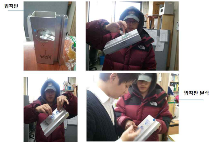
<그림 3-13> 압착판 방식의 부착력 테스트
