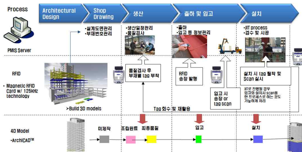
<그림 3-36> 기존 RFID+4D 시스템의 철골 프로세스
