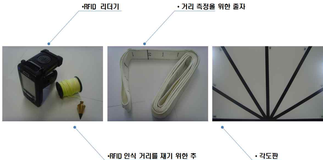
<그림 3-21> Tag 부착 장치 테스트를 위한 실험 도구
