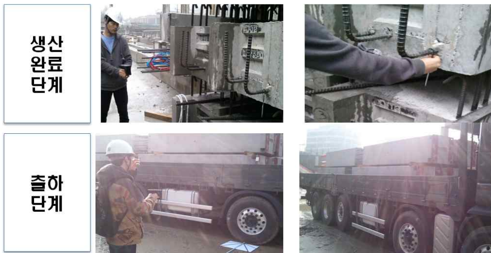
<그림 3-99> 고리 타입의 공장 테스트 모습
