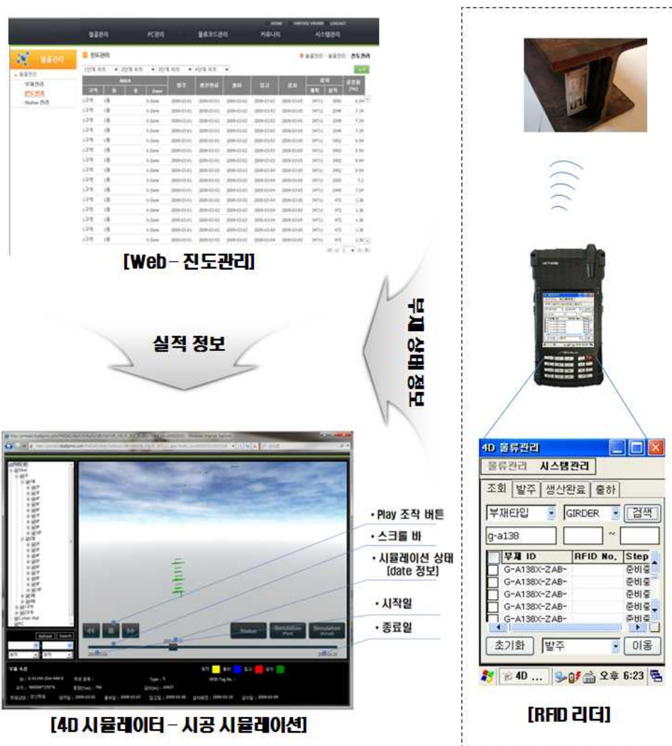
<그림 3-44> RFID+4D 시스템과 웹 기반 실시간 4D Viewer의 관계
