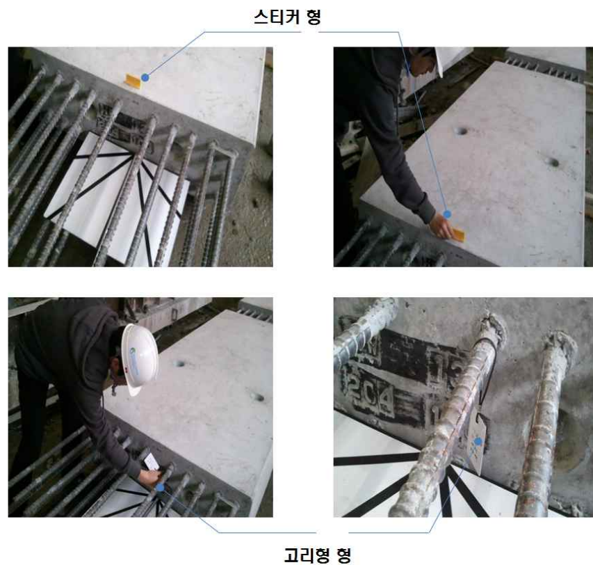
<그림 3-96> PC 공장 및 현장 테스트를 위한 RFID tag 부착 위치
