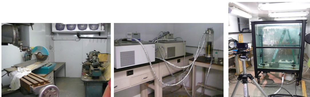
그림 2.58 저온챔버내 시료준비실과 극저온냉동챔버내 삼축압축실험과 결빙실험
