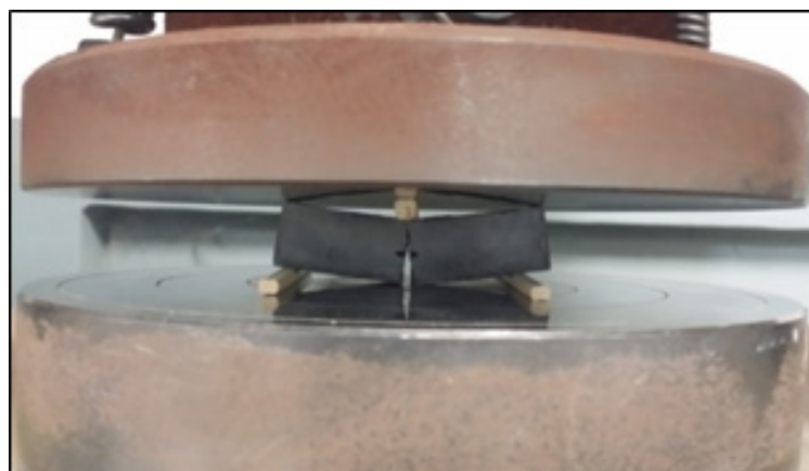
그림 2-10. Cracking of CNT/cement composite.
