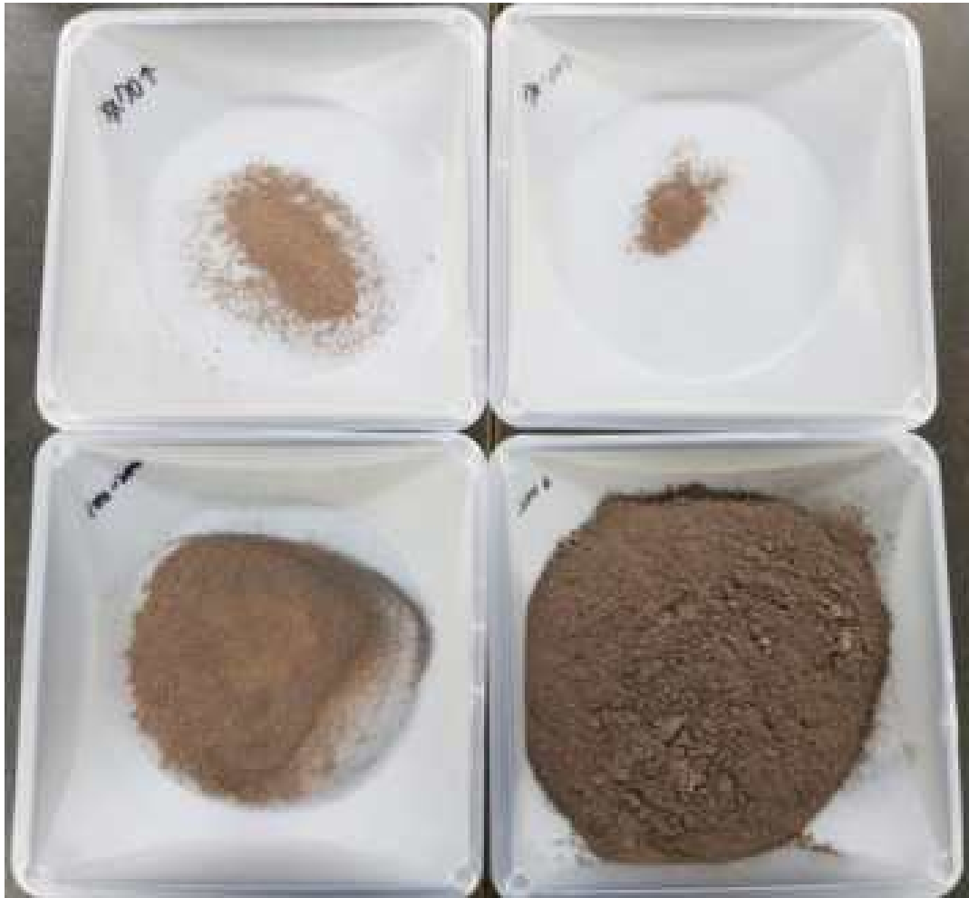
그림 3.34 고칼슘 비산화 체질 결과 (좌상 #70over, 우상 #70~#100, 좌하 #100~#200, 우하 #200under)
