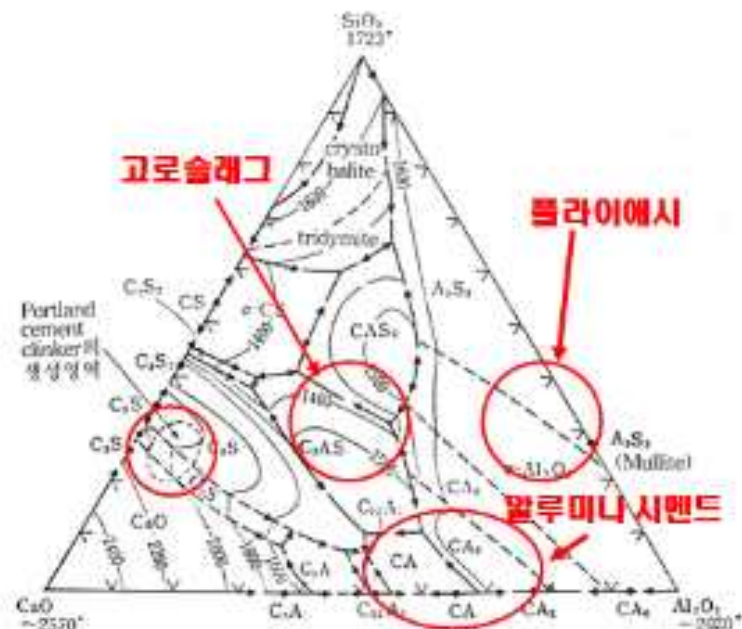
그림 3.22 시멘트계 재료의 \text{SiO}_2 , \text{CaO} , \text{Al}_2\text{O}_3 3성분계 도표
