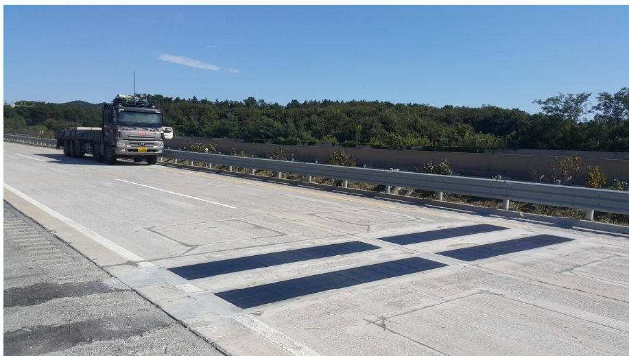
[그림 3.14] 벤딩플레이트 시스템 검지부 센서 설치 전경
