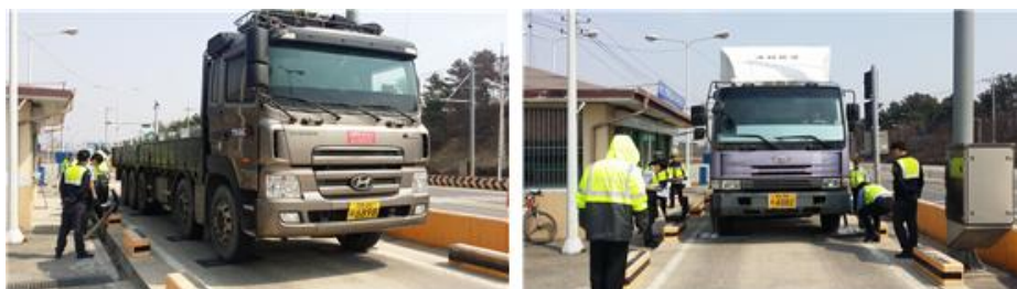
[그림 3.62] ⑥, ⑦ 과적 검문소의 저속축중기 및 이동식 축중기 측정
