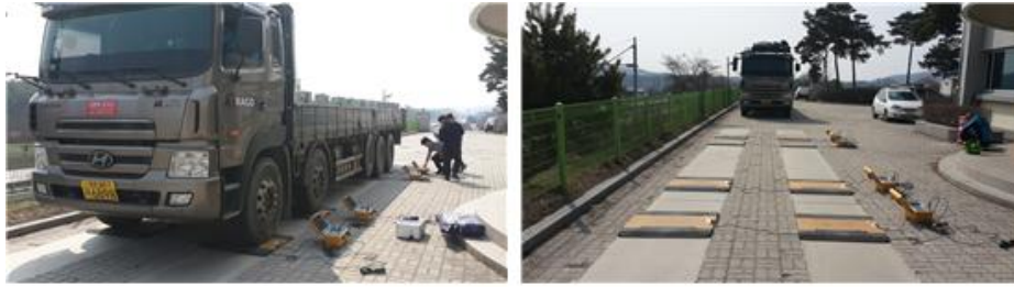
[그림 3.60] ④ 평탄 노면에서 이동식 축중기로 전륜 동시 측정
