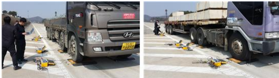
[그림 3.61] ⑤ 본선에서 이동식 축중기 및 더미판을 이용한 측정
