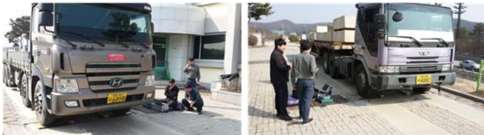
[그림 3.58] ① 이동식 축중기 고정 홈을 이용한 측정
