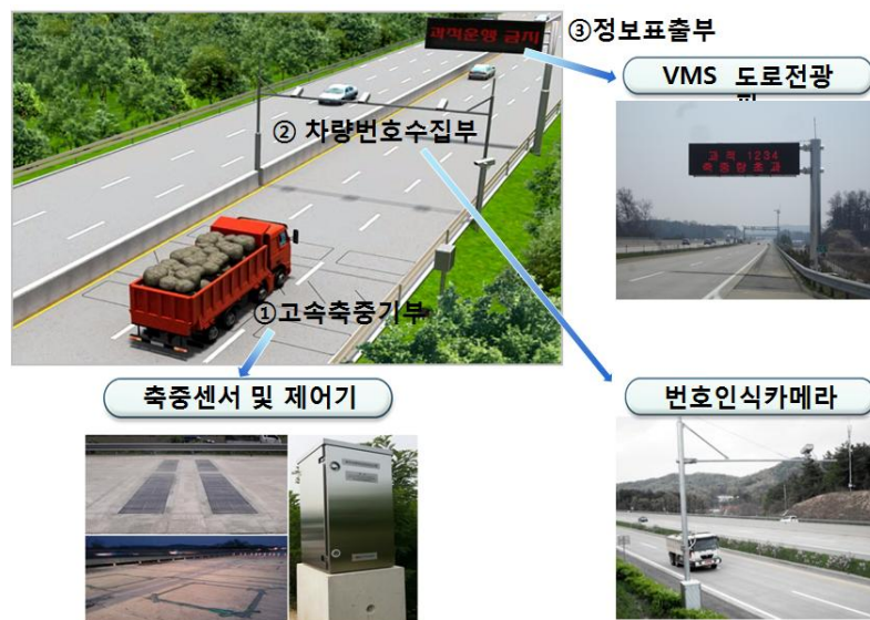
[그림 3.1] 고속축중기를 이용한 고속 무인 과적단속시스템의 일반적 구성
