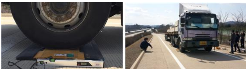
[그림 3.63] ⑧ 경사진 노면에서 이동식 축중기를 이용한 측정
