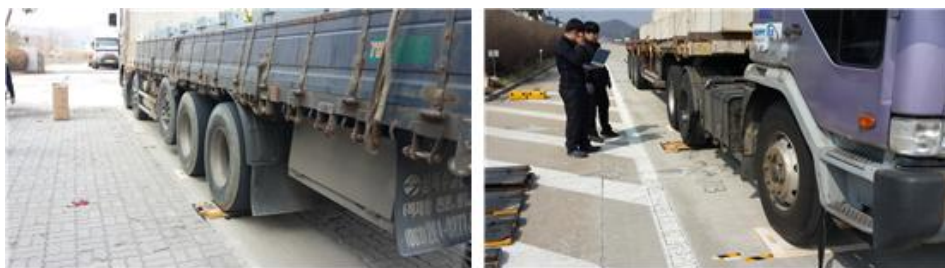
[그림 3.59] ② 평탄 노면에서 이동식 축중기와 더미를 이용한 측정
