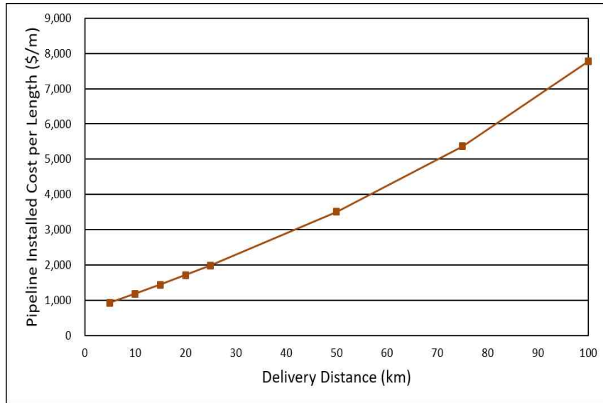
<그림 3.34. 이송거리에 따른 수소가스배관의 단위길이당 설치비용>
