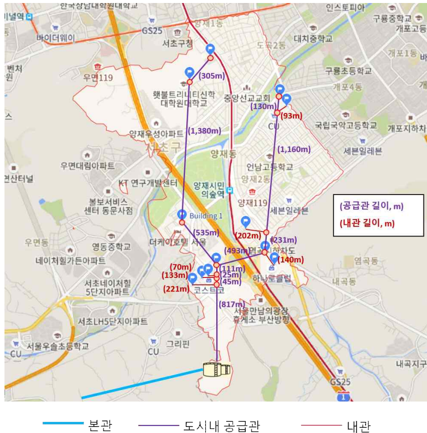
<그림 3.29. 양재동 대형건물 발전용 연료전지의 수소배관망 설치안>
