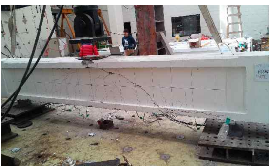
(a) 파괴 시 균열 양상
