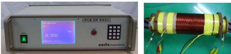
<그림 2.3-2> 에이팩스 솔루션이 제작한 마그네틱 장력 센서 및 측정 장치
