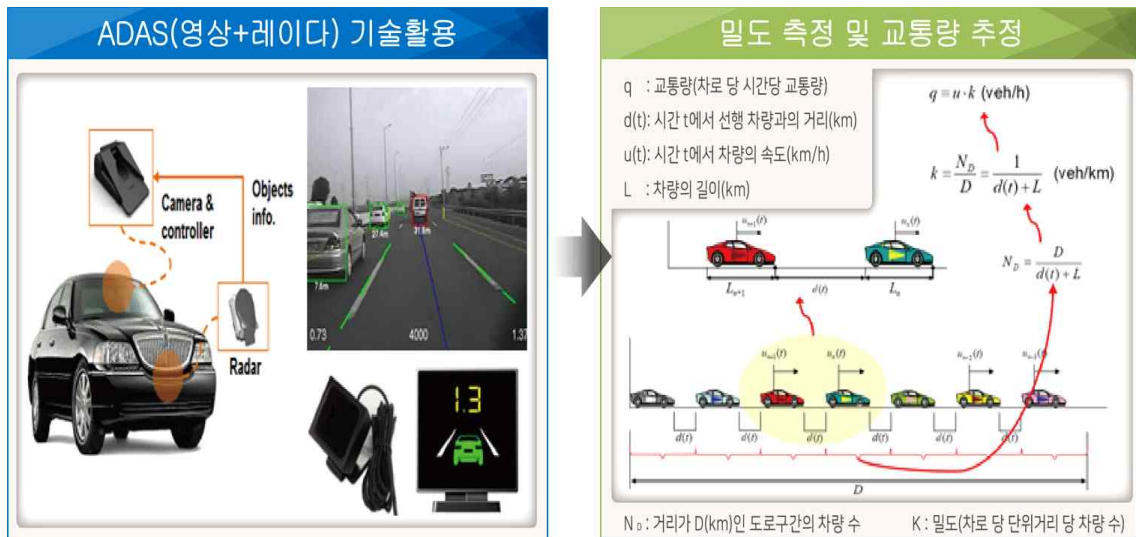
<ADAS 센서 활용 차량 간 차두거리 기반 교통 밀도 측정 및 교통량 추정>
