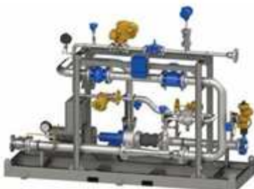
<차량 탑재 가능한 마이크로버블 미세기포 발생장치 모듈화 예시>
