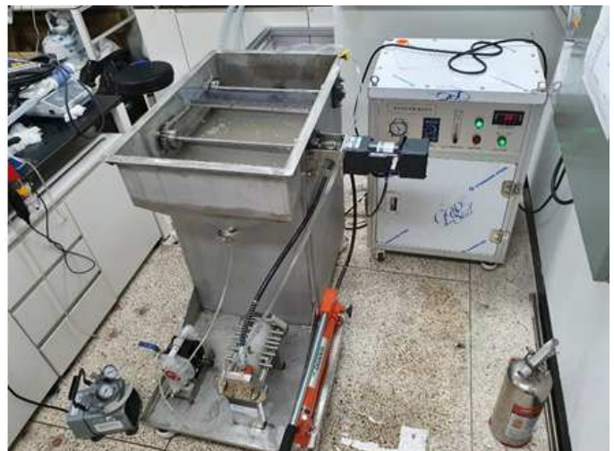
<30 LPM 급 입자 부상분리 DAF 시스템 설계도면 및 장치>
