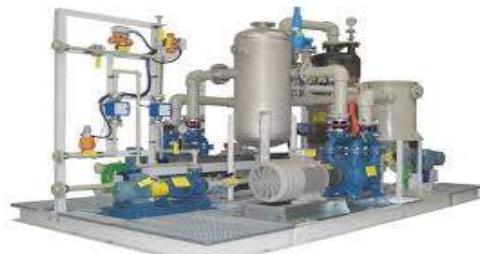
<차량 탑재 가능한 오염세정수 입자 부상분리 시스템 모듈화 예시>
