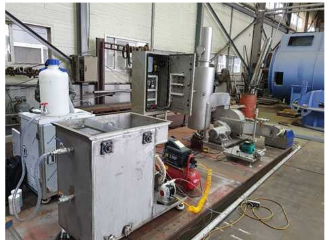
<DMV+용존공기부상장치 결합 설계도면 및 실제 결합 장치 사진>
