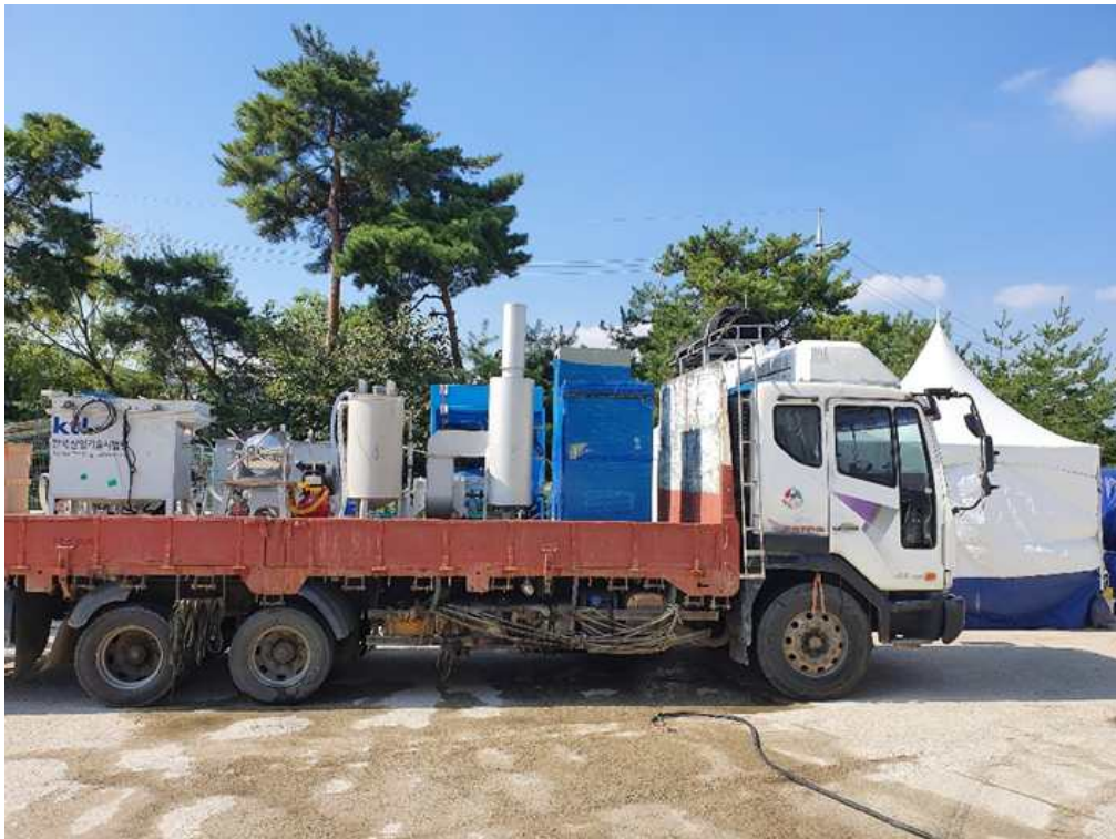
<DMV+용존공기부상장치 장치 결합 및 차량 탑재>
