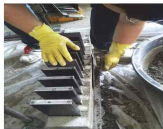
[균열 유도판을 활용한 균열 유도 콘크리트 시편 제작]
