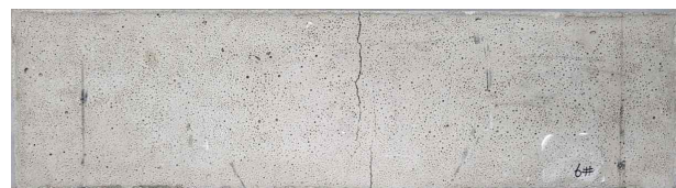
[다양한 폭의 균열을 발생시킨 콘크리트 시편 결과물]
