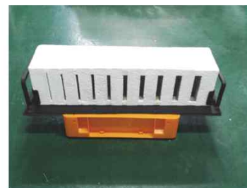
[균열 유도판을 활용한 균열 유도 콘크리트 시편 제작]
