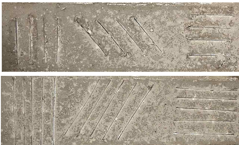
[균열 유도판을 통한 미세균열 제작 결과물]
