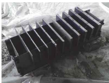
[균열 유도판을 활용한 균열 유도 콘크리트 시편 제작]
