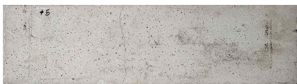
[다양한 폭의 균열을 발생시킨 콘크리트 시편 결과물]
