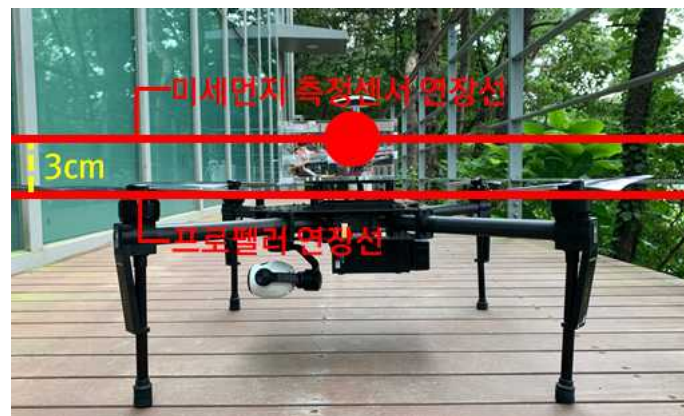
<그림 2-19> 드론에 탑재한 미세먼지 센서
