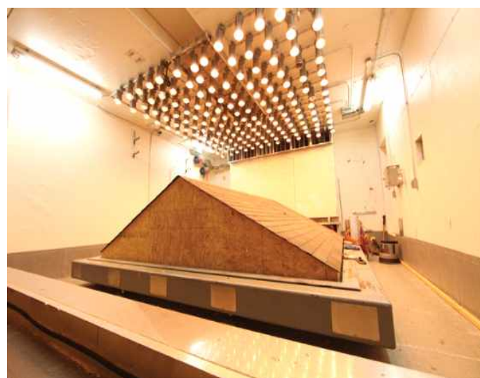
그림 58. Large scale climate simulator를 이용하여 PCM을 적용한 지붕재에 테스트 장면
