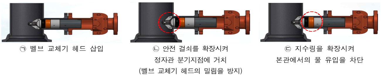
[그림 2.1] 무단수 밸브교체시 작동 시스템(안)
