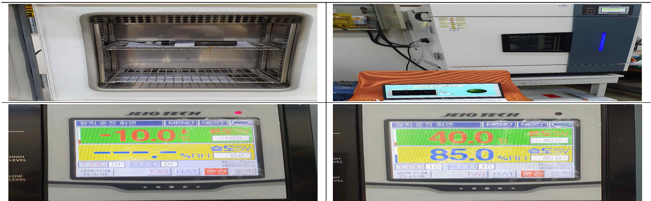
[그림 2.13] 저온/고온 고습 시험 셋업
