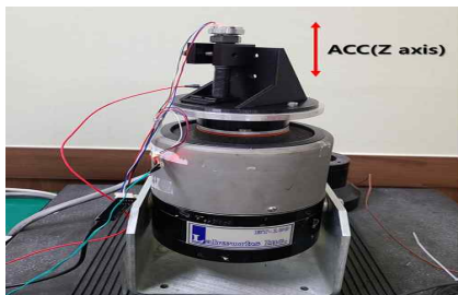
[그림 3.20] 가진기를 이용한 가속도 수집 테스트 셋업(좌) 및 결과(우)
