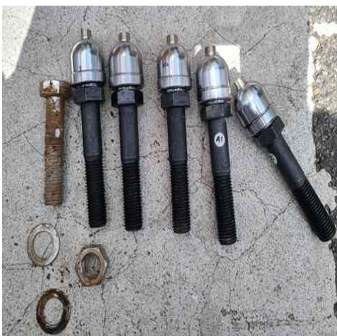
[그림 3.6] 기존 볼트 및 실험용 스마트볼트, 현장 설치용 스마트볼트, 스마트볼트 설치 모습
