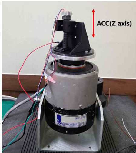
[가진기를 이용한 가속도 수집 테스트 및 그 결과]
