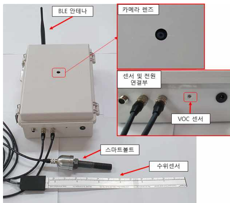
[그림 2.22] 누수 검출 상태 감시 장치 제작품
