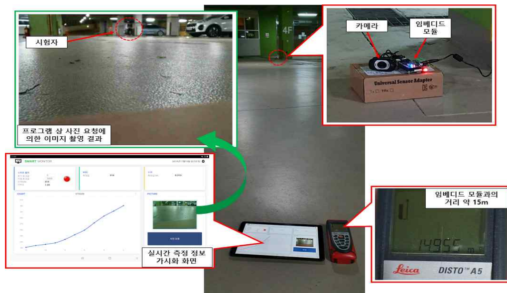
[그림 2.43] BLE 통신 모듈 무선 성능 시험
