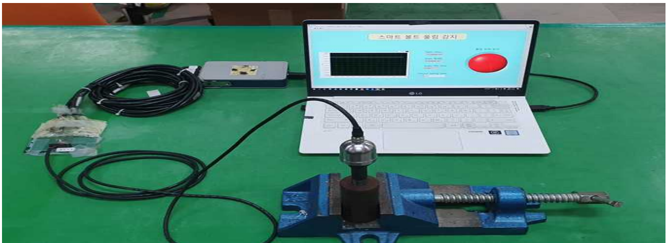
[그림 2.17] 스마트볼트 풀림 감지 시험 셋업
