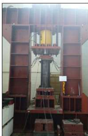
그림 3.4.7 OCFT 기둥 중심축 압축실험 및 단면상세
