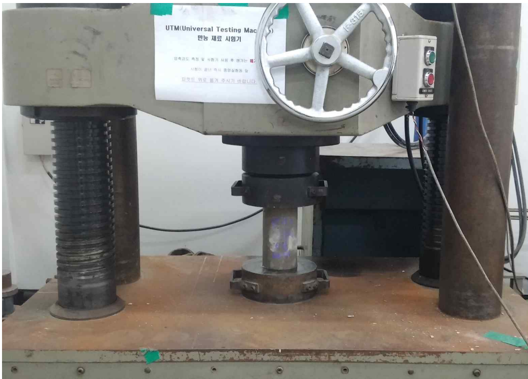
그림 3.4.6 콘크리트 공시체 압축강도 실험
