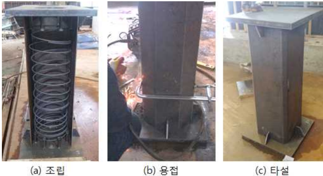
그림 3.4.8 OCFT 단주 실험체 제작과정 (2016.03.08. 페트라텍)
