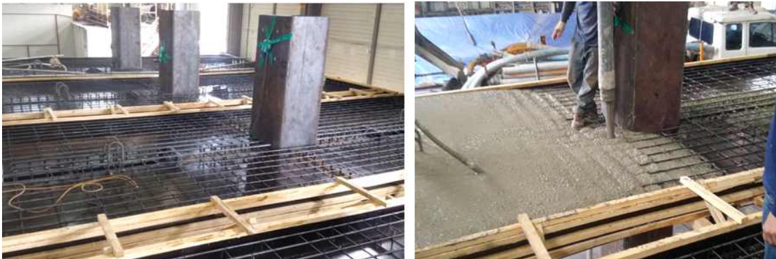
그림 3.5.6 내부접합부 실험체 제작 (페트라텍, 2016.10.11.)
