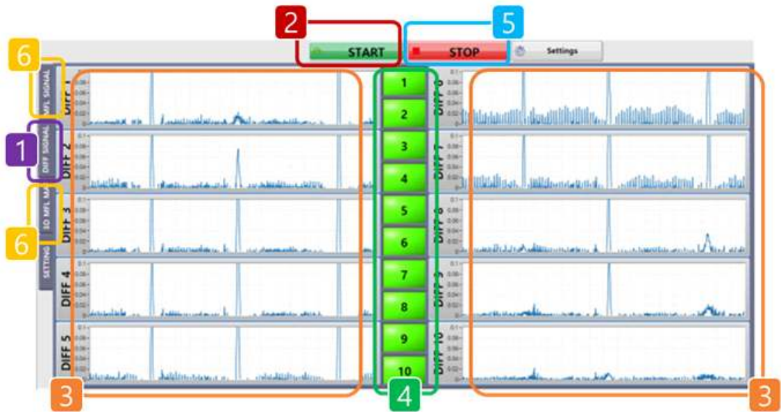
<DIFF SIGNAL Tab을 이용한 채널별 자속 차분 값 신호 모니터링>
