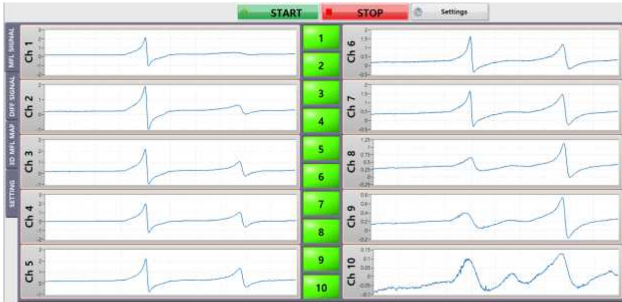
<채널별 누설자속신호 디스플레이 탭을 이용한 신호 모니터링>
