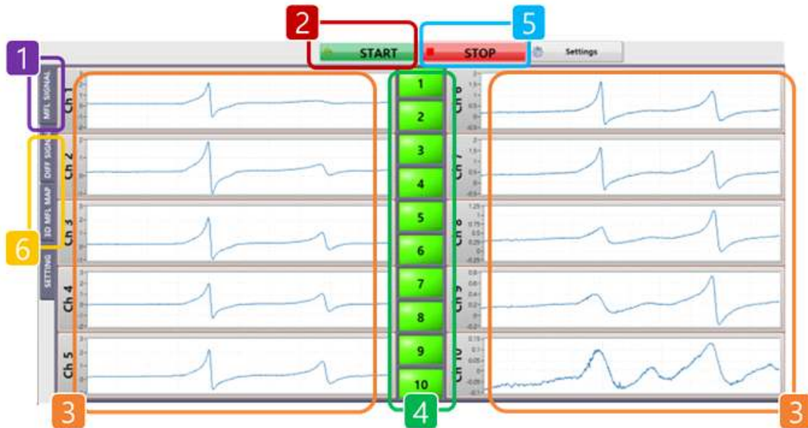
<MFL SIGNAL Tab을 이용한 채널별 누설자속신호 모니터링>
