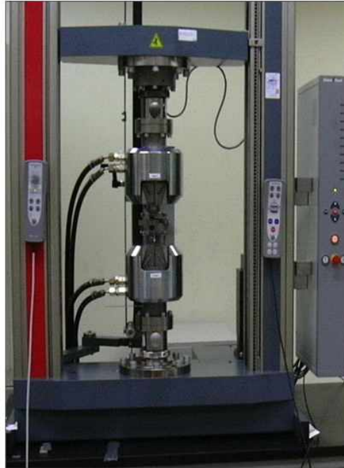
그림 1-9 인장강도 측정을 위한 분석기기 (ZWICK Z100, ZWICK/Roell)
