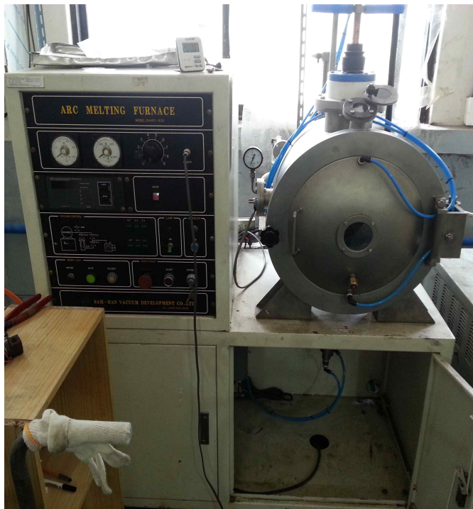
그림 1-1 Arc melting furnace 및 모식도
