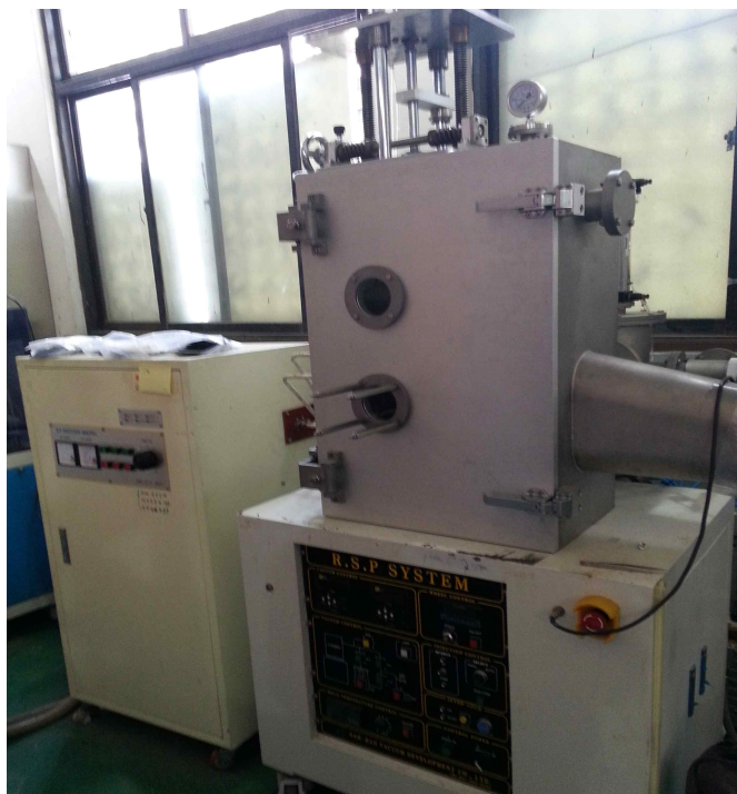
그림 1-2 Melt spinner 및 모식도
