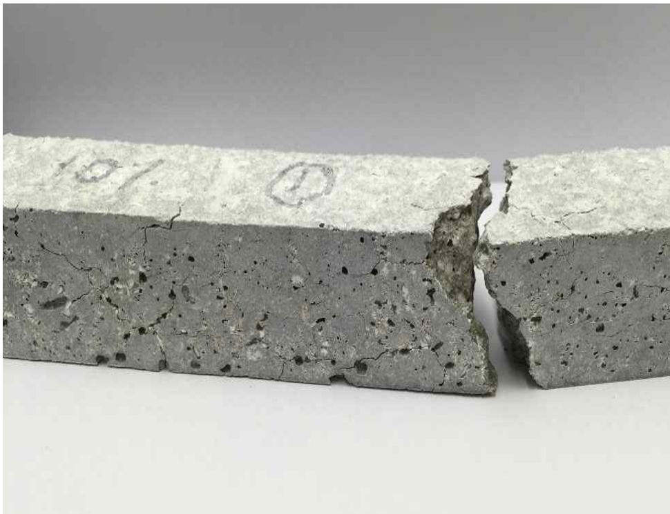
그림. 3-3 ASR 팽창으로 파괴된 모르타르 막대 시편의 균열부
