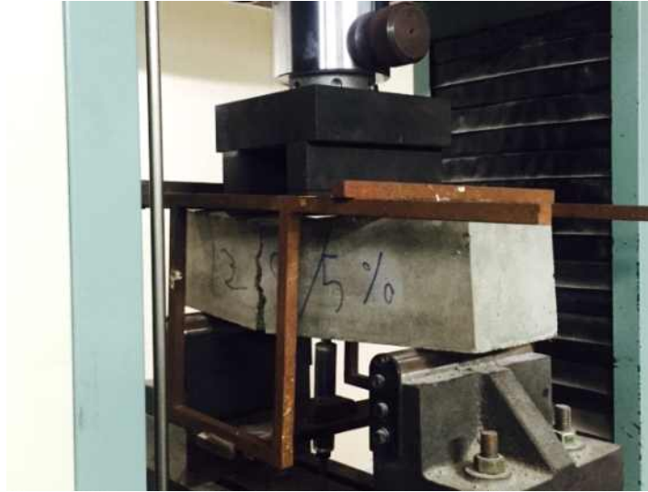
그림. 2-5. 경화된 콘크리트의 휨강도 실험
