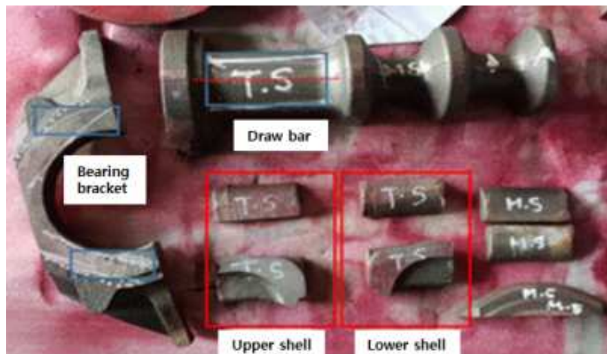
<그림 2.109> EFG2 고무완충기 주물부품의 본품 시편 채취 사진
