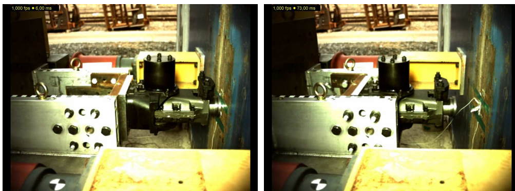
<그림 2.175> Shear-off 고속촬영 영상 캡처(좌: 충돌시험, 우: Shear-off 직후)
