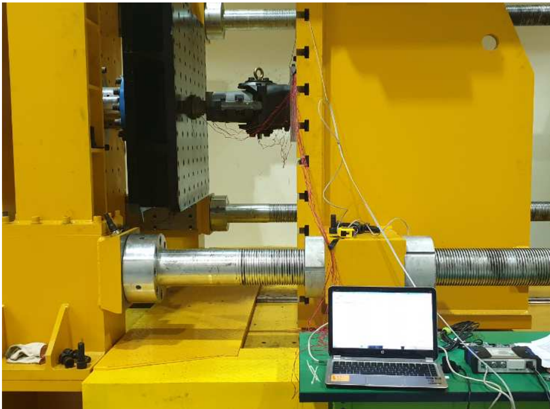
<그림 2.162> EFG3 정하중 강도시험 셋팅
