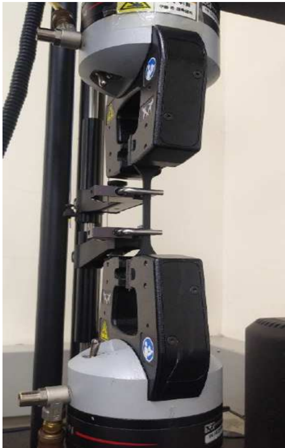
<그림 2.48> 완충기용 고무 시편 인장 시험
