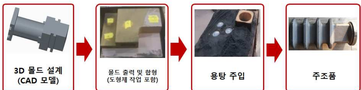
<그림 2.118> EFG3 Drawbar 몰드 설계 후 몰드 제작 및 주조품 생산 과정
