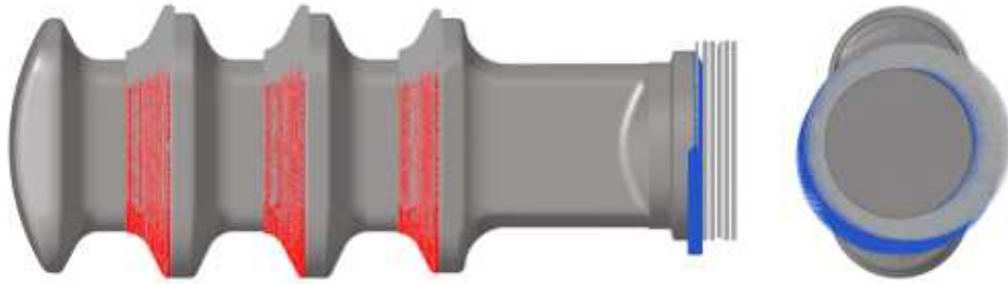
<그림 2.31> Draw bar 해석모델 하중 및 경계조건(압축하중)
