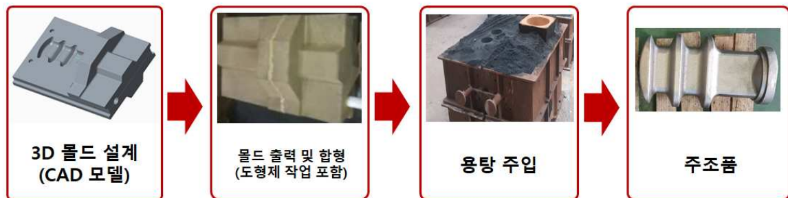
<그림 2.102> EFG2 Drawbar 몰드 설계 후 몰드 제작 및 주조품 생산 과정
