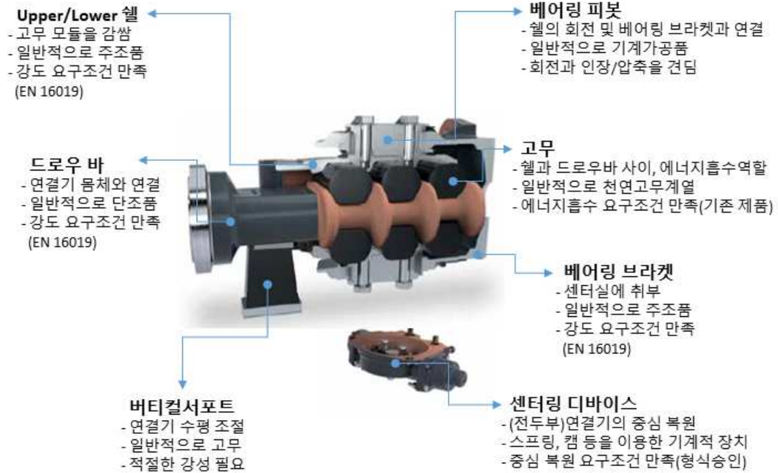
<그림 1.4> EFG형식 고무완충기의 핵심부품도(그림: Voith Turbo 카탈로그 발췌)
