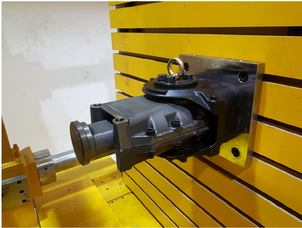
<그림 2.157> 2차 시제품(EFG3) 정적 하중시험 셋팅
