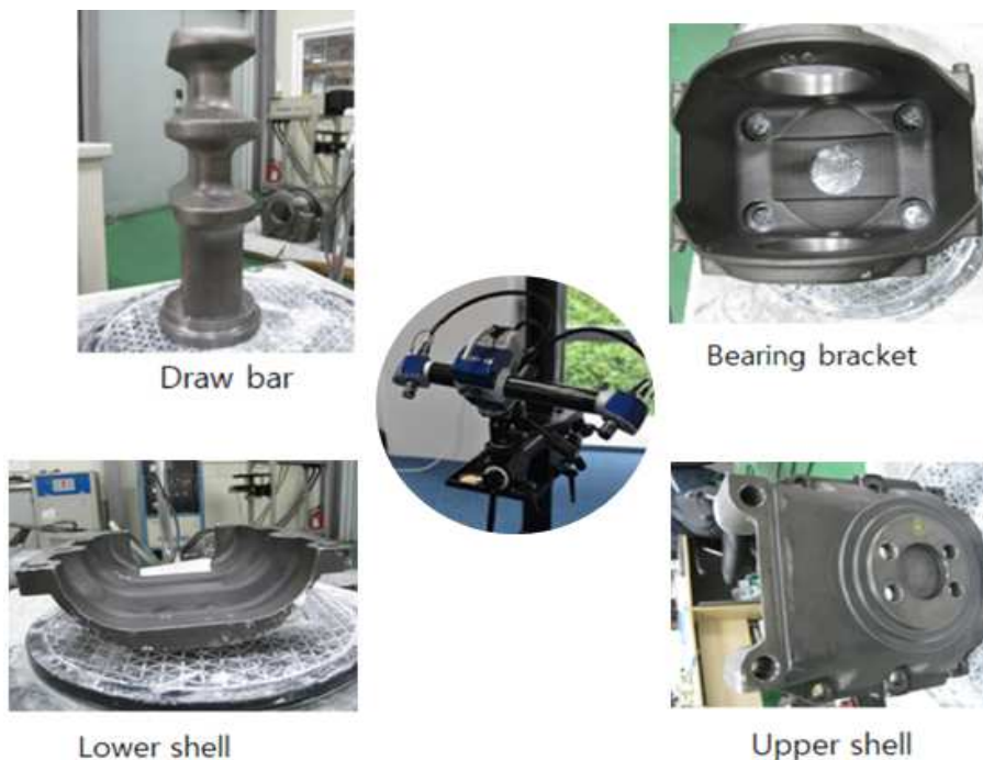
<그림 2.2> EFG 형식 고무완충기 주요 부품의 3차원 스캔 작업
