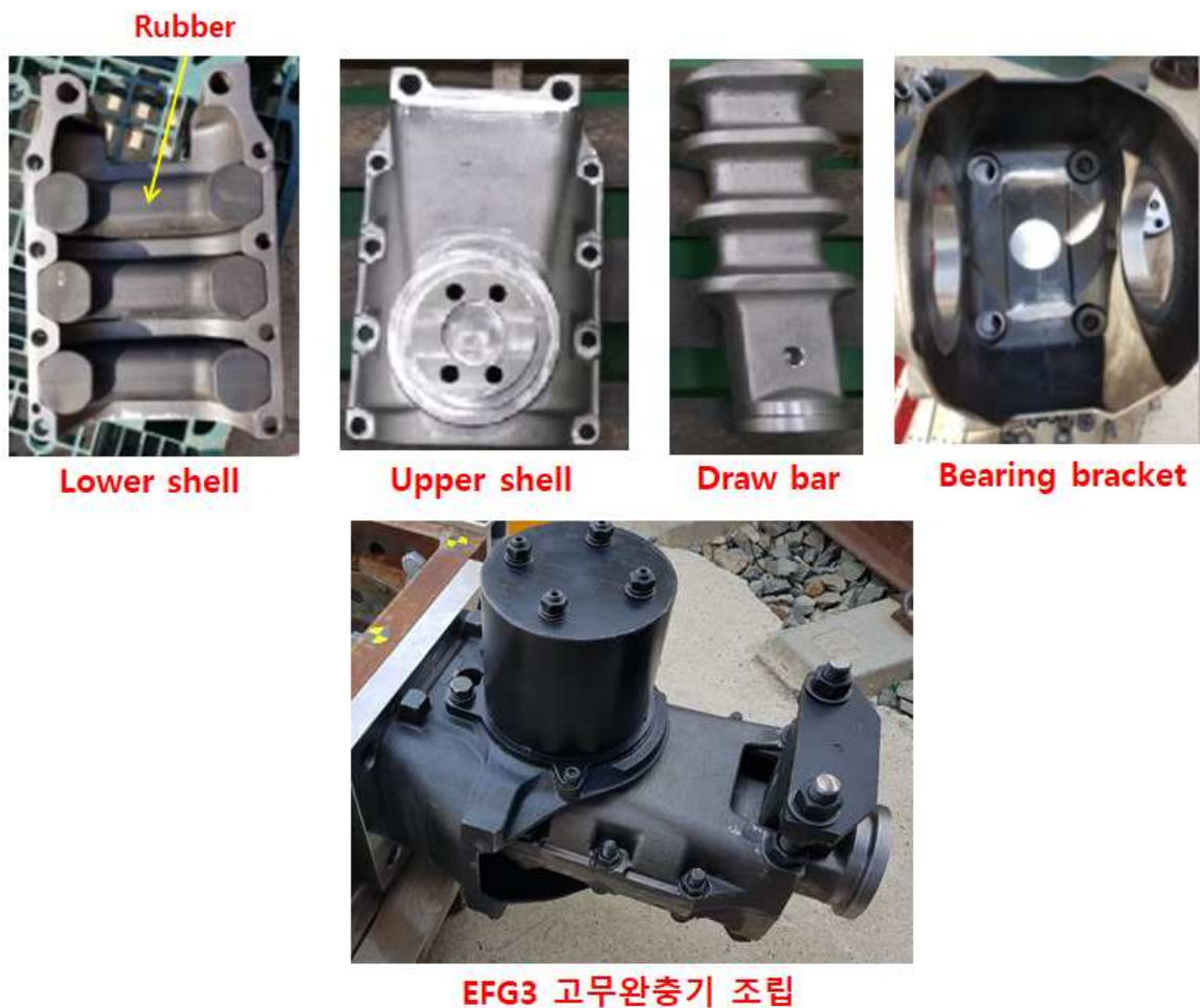
<그림 2.123> EFG3 고무완충기 시제품
