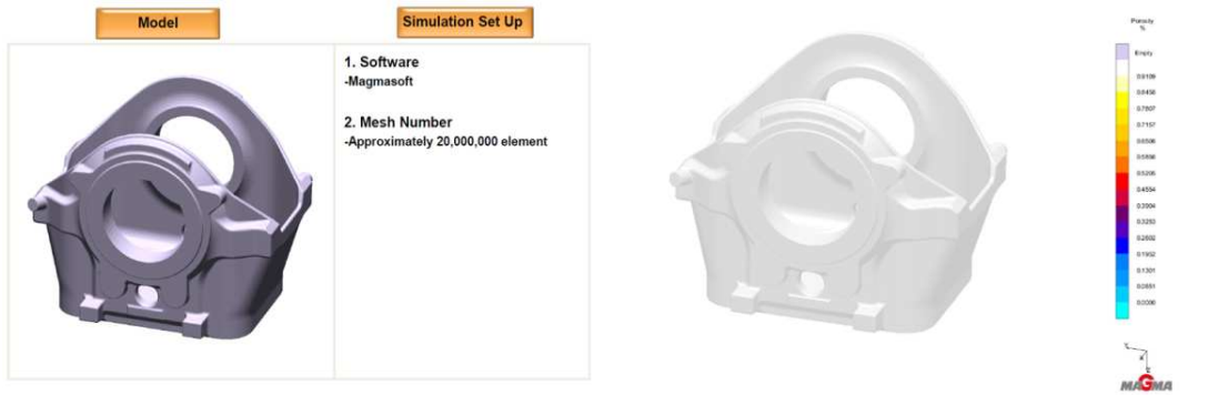
(a) Bearing Bracket 주조 해석 결과
