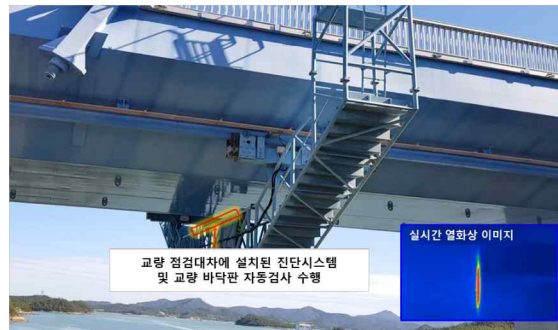
진단시스템의 교량 점검대차 (추가 검토 무인체) 통합을 통한 교량 바닥판 자동 검사 수행
