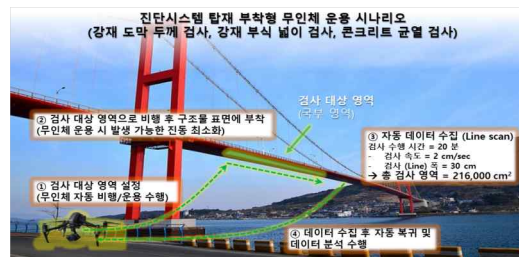
도막두께 및 부식깊이 진단시스템 (진단시스템) 탑재 무인체 운용 시나리오
