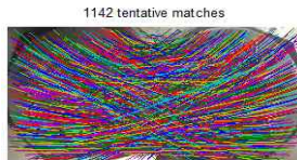
실제 볼트폴림 이미지로부터 SIFT 및 RANSAC 알고리즘을 적용한 결과
