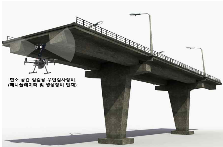
협소공간 점검을 위한 매니플레이터 및 벽면 부착기능을 보유한 무인검사장비 (예시)
