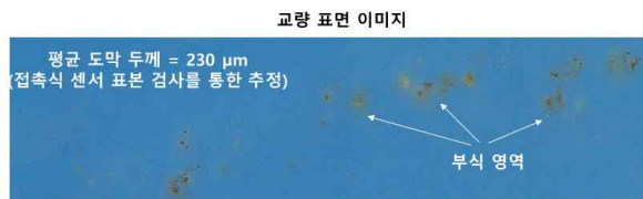
실 교량 볼트 시공영역에 대한 진단시스템 성능검증 결과
