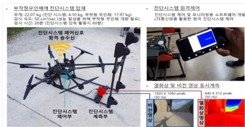
도막두께 및 부식깊이 진단시스템 (진단시스템) 무인체 탑재 및 운용
