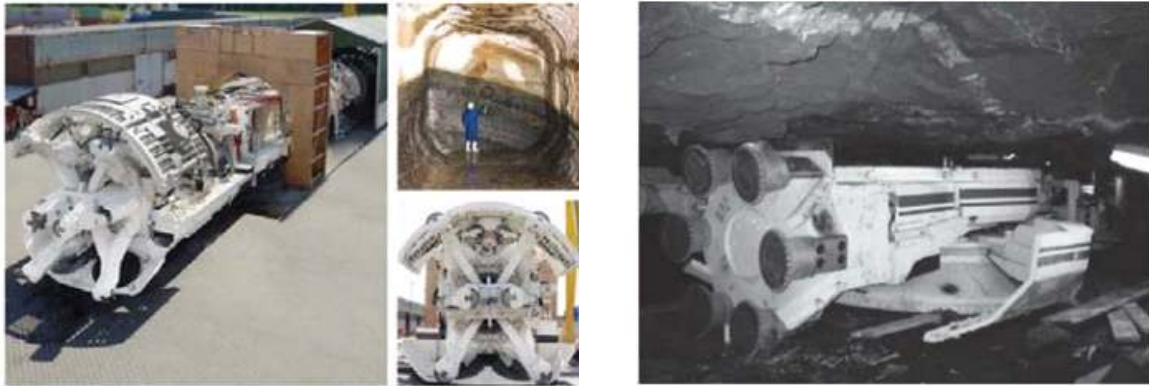
그림 2.2. Aker Solutions와 Sandvik사에서 개발한 언더커팅방식을 적용한 기계굴착장비
