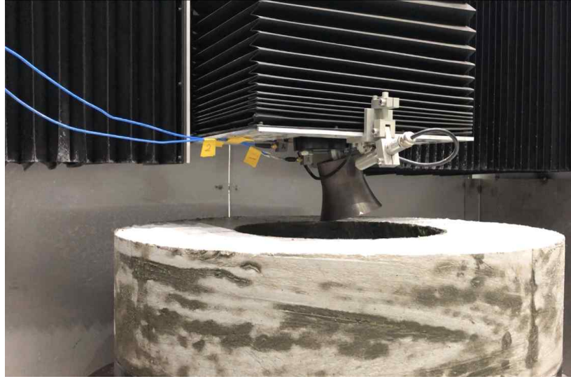
그림 2.34. 회전 절삭시험 시험편 세팅 사진
