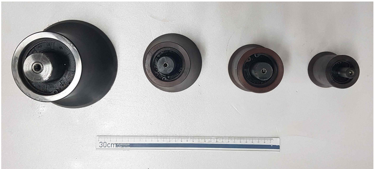
그림 2.11. 본 연구에서 제작한 언더커팅 디스크 커터 (커터링 직경 150 mm, 100 mm, 80 mm, 60 mm)
