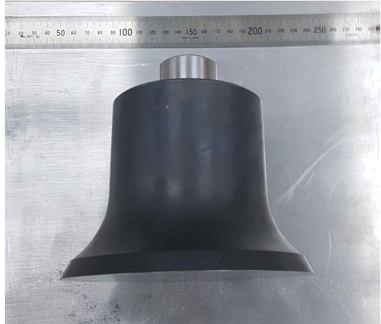
그림 2.10. 본 연구에서 제작한 언더커팅 디스크 커터 (커터링 직경 150 mm)
