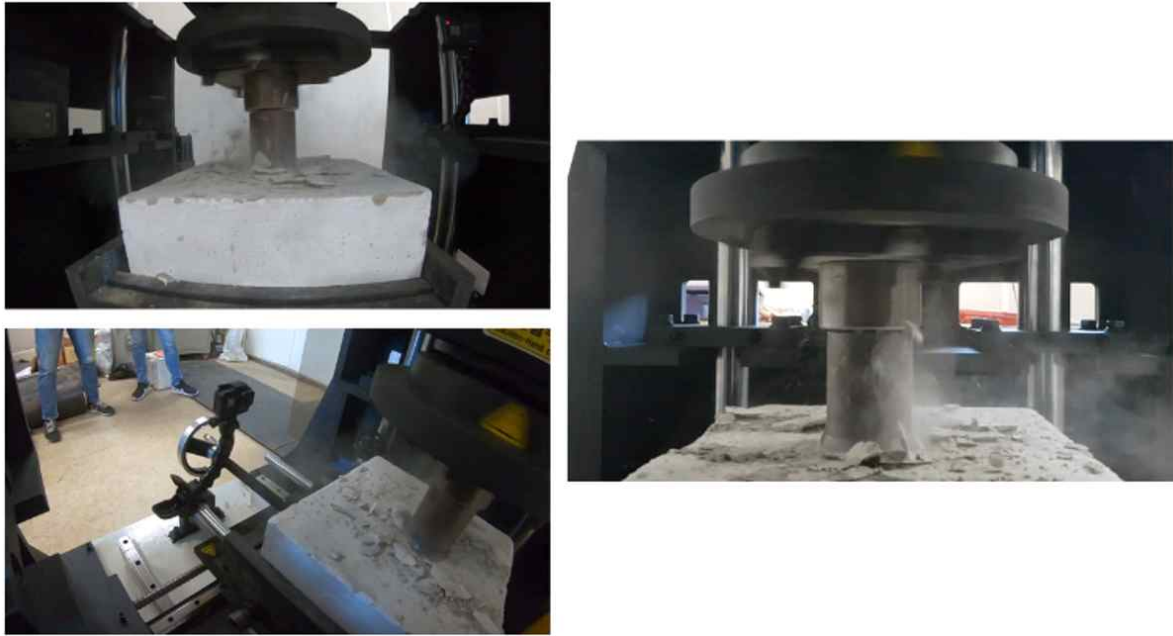
그림 2.23. 본 연구에서 수행된 언더커팅 절삭시험의 전경
