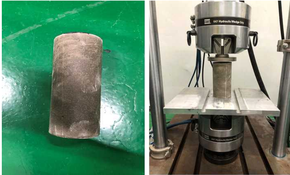
그림 2.33 양생된 시멘트 공시체와 일축압축시험 전경
