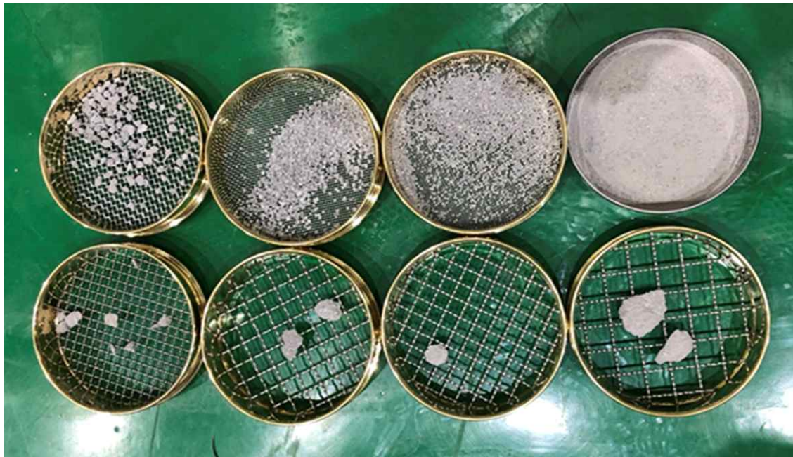
그림 2.42. 절삭시험 후 회수된 버력의 체가름 분석
