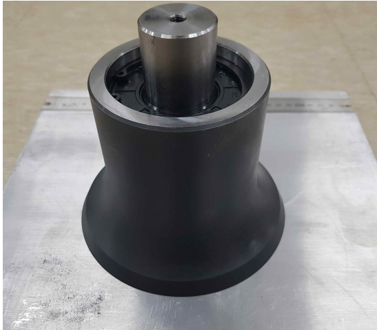
그림 2.10. 본 연구에서 제작한 언더커팅 디스크 커터 (커터링 직경 150 mm)
