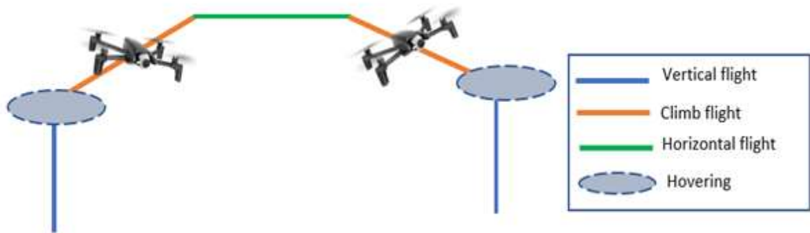
그림 71 General flight mission profile for multicopter drone
