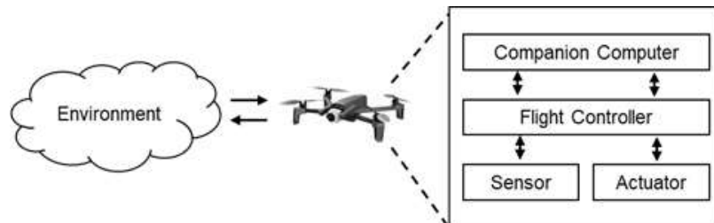
그림 135 Closed-loop data flow in a UAV in real-world
