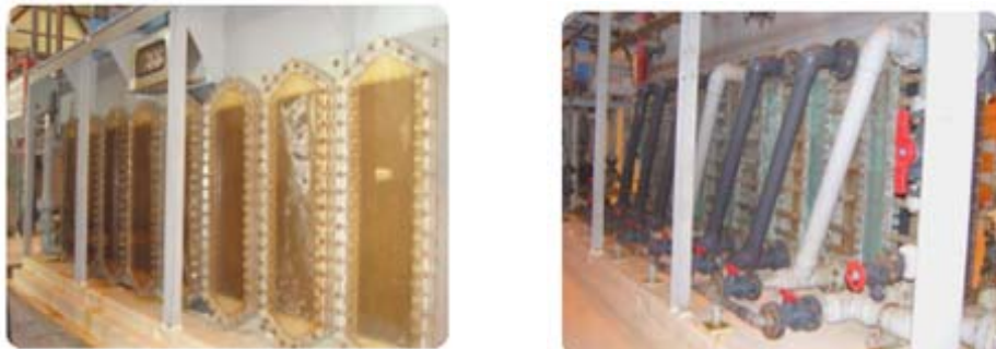
[그림 1.2.3] Mono-polar형 해수전해장치
