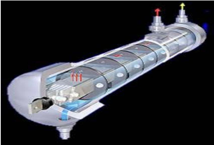
[그림 3.2.15] Bi-Polar형 전해반응기의 개념도
