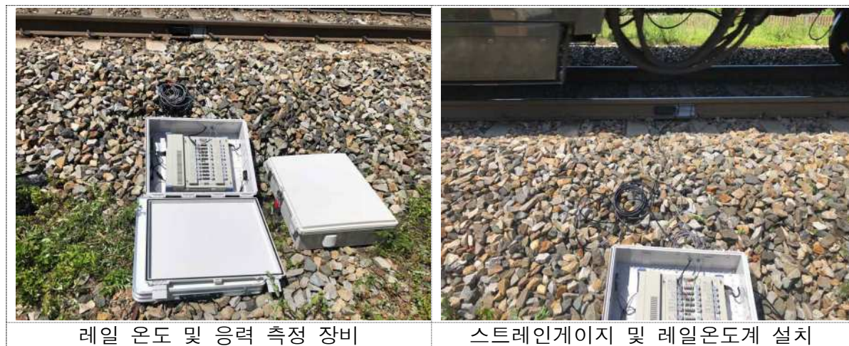
그림 2.37 레일 온도 및 응력 측정
