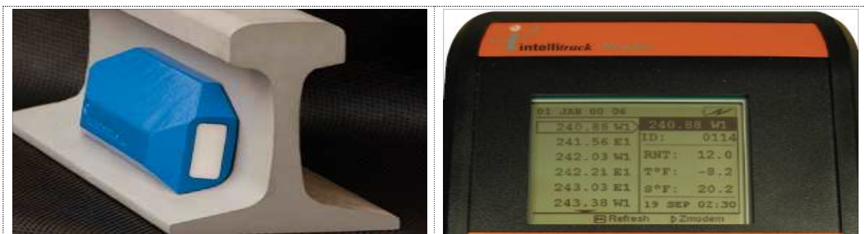
그림 1.16 RSM를 이용한 응력, 레일온도, 중립온도 측정
