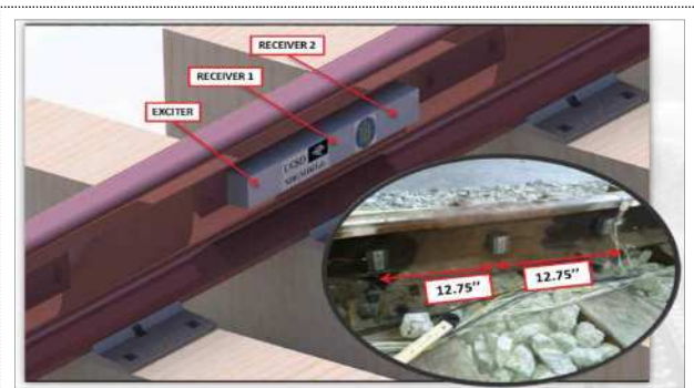
그림 1.19 비선형 유도 초음파를 이용한 중립온도 측정
