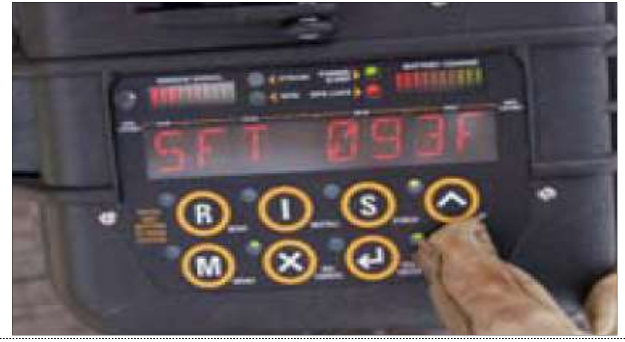
그림 1.17 SFTPRO를 이용한 응력, 레일온도, 중립온도 측정
