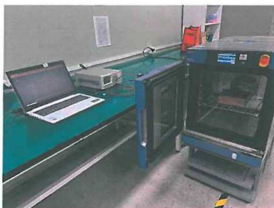
그림 3.71 고온 및 저온 동작시험(환경시험) 수행 사진
