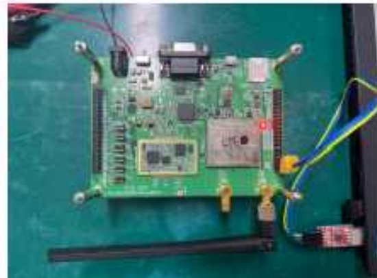
Figure 11. 전원인가 후 모듈 동작확인사진
