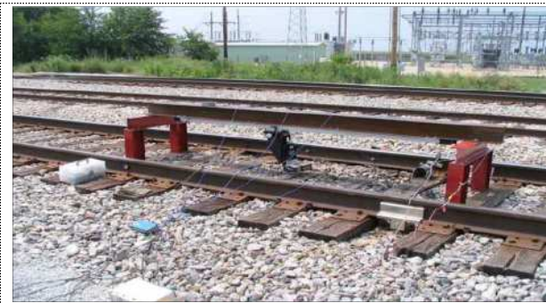
그림 1.18 진동을 이용한 중립온도 측정
