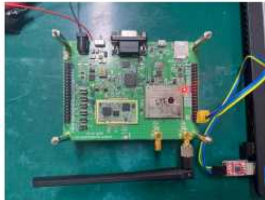
Figure 11. 전원인가 후 모듈 동작확인사진
