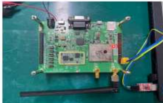
Figure 11. 전원인가 후 모듈 동작확인사진
