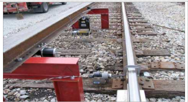
그림 1.18 진동을 이용한 중립온도 측정
