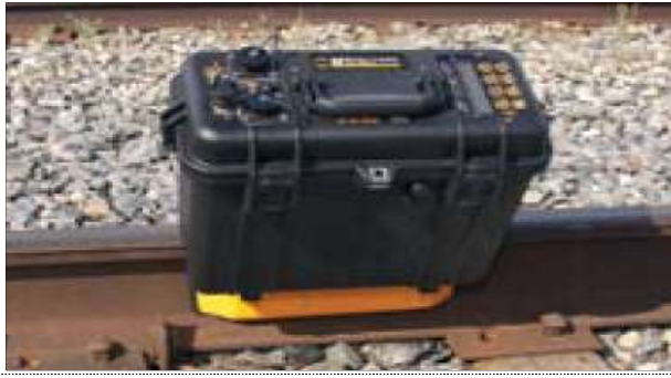
그림 1.17 SFTPRO를 이용한 응력, 레일온도, 중립온도 측정
