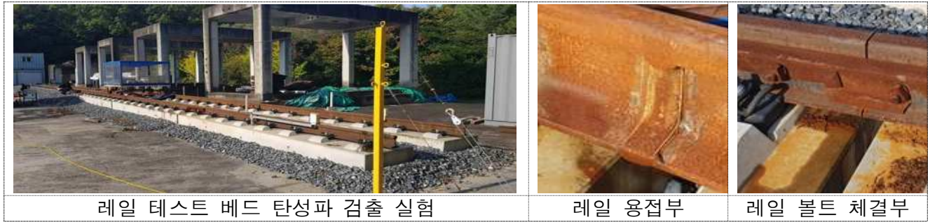
그림 2.22 테스트베드 탄성과 검출 실험
