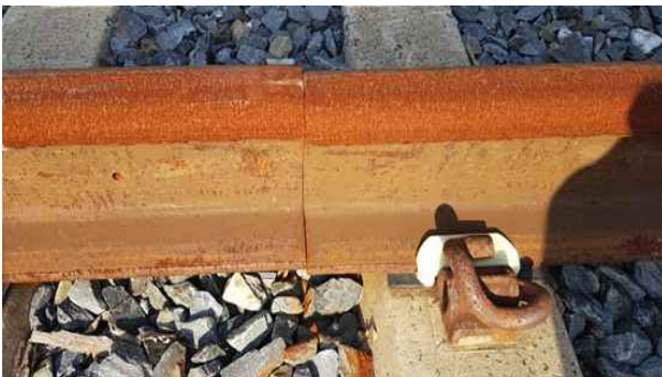
그림 3.58 물리적으로 접촉된 절손상태 레일에 대한 탄성파 검출 시험
