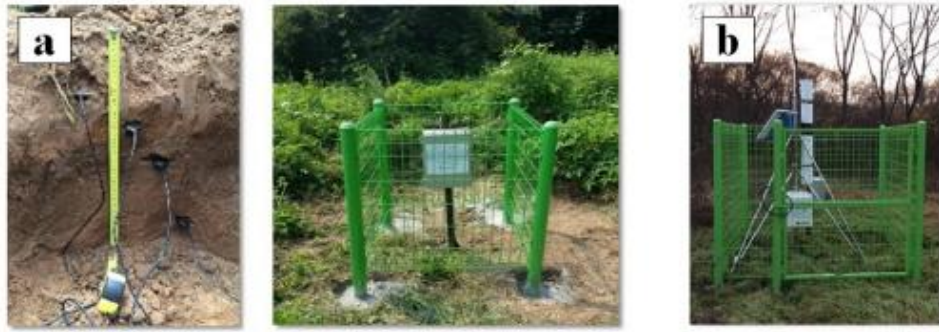
Fig. 2.1.2 (a) FDR 센서 설치 토양 단면 FDR 센서 및 (b) CRNP
