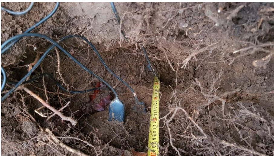
Fig. 3.1.42 설마천 연구지역에 설치된 유전율식 센서의 깊이와 개수
