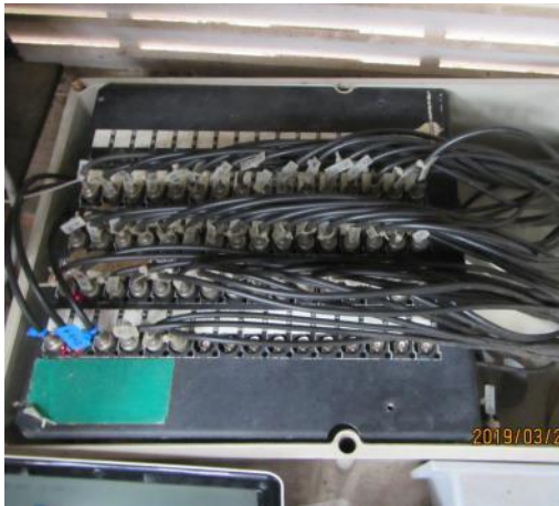
Fig. 3.2.60 설마천 유역 TDR 관측소의 MUX와 배터리
