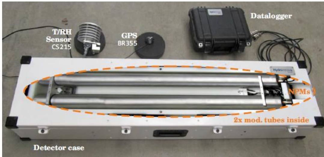
Fig. 6.2.2 CRNS 로버에 장착되는 구성품 들, 주황색으로 표시된 내부는 두 개의 원자로 튜브로 이루어짐 (Schrön et al., 2017)
