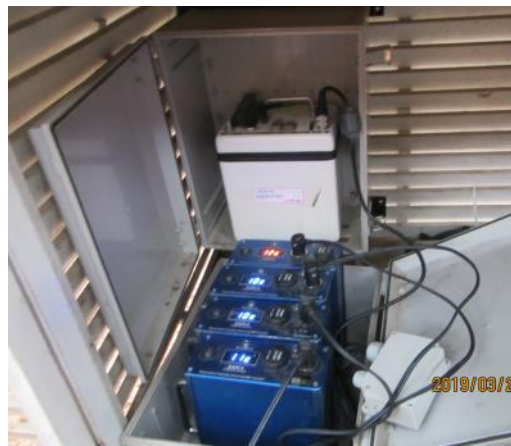
Fig. 3.2.60 설마천 유역 TDR 관측소의 MUX와 배터리
