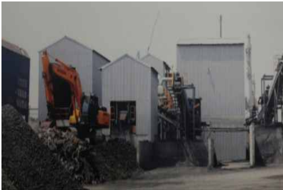
그림 3.38 슬래그골재 제조 설비
