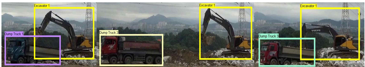
그림 43. 투입 장비 현황 자동 인식 모델의 성능 시험 결과(정확도 96.5%) 예시.
