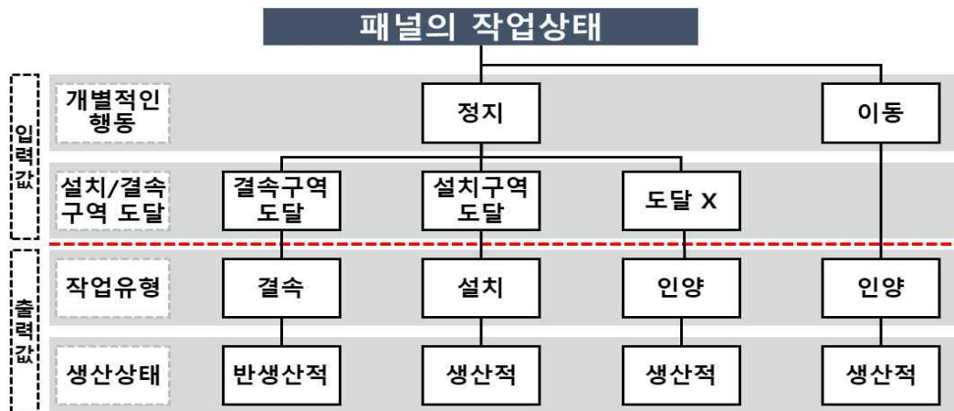
그림 56. 패널의 개별적인 행동 및 설치구역 도달 여부기반 생산상태, 작업유형 분석 방법.
