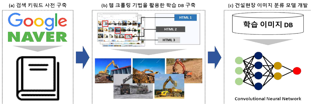
그림 39. 작업공종 자동 분류 모델 알고리즘 순서도.
