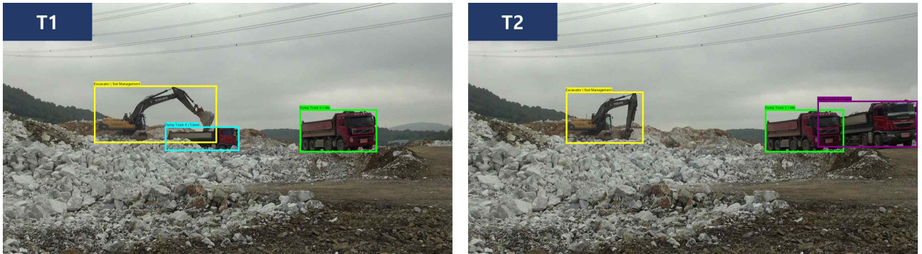
그림 81. 덤프트럭 추적 오류(덤프트럭의 ID가 지속적으로 인식되지 않은 경우)의 예시.
