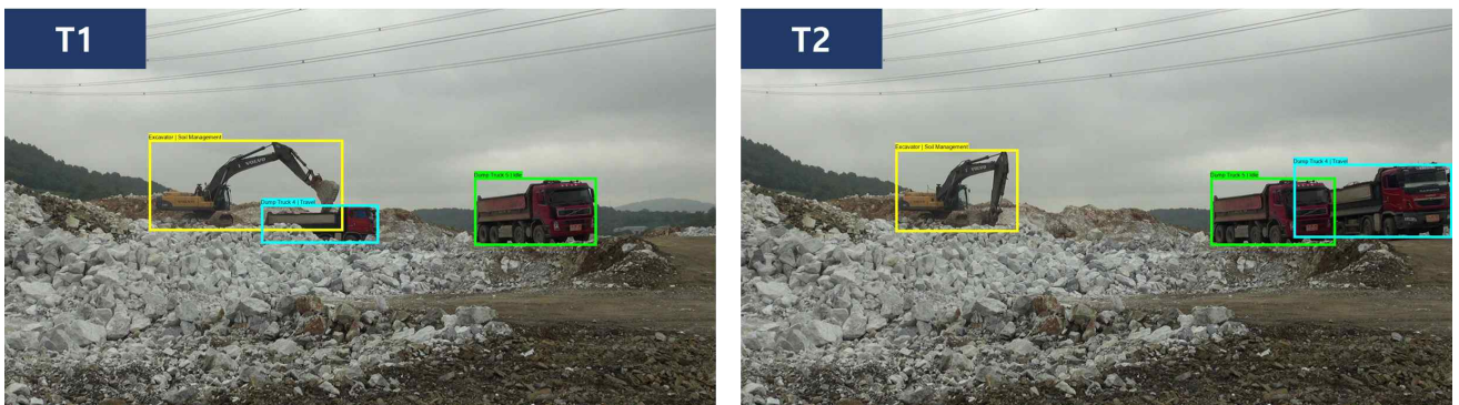
그림 82. 덤프트럭 추적 오류 보완 후 결과(덤프트럭의 ID가 지속적으로 인식된 경우) 예시.
