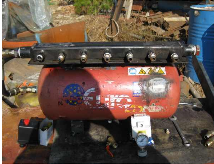
〈그림 3.38〉 노즐부 청소관리를 위한 Air pressure
