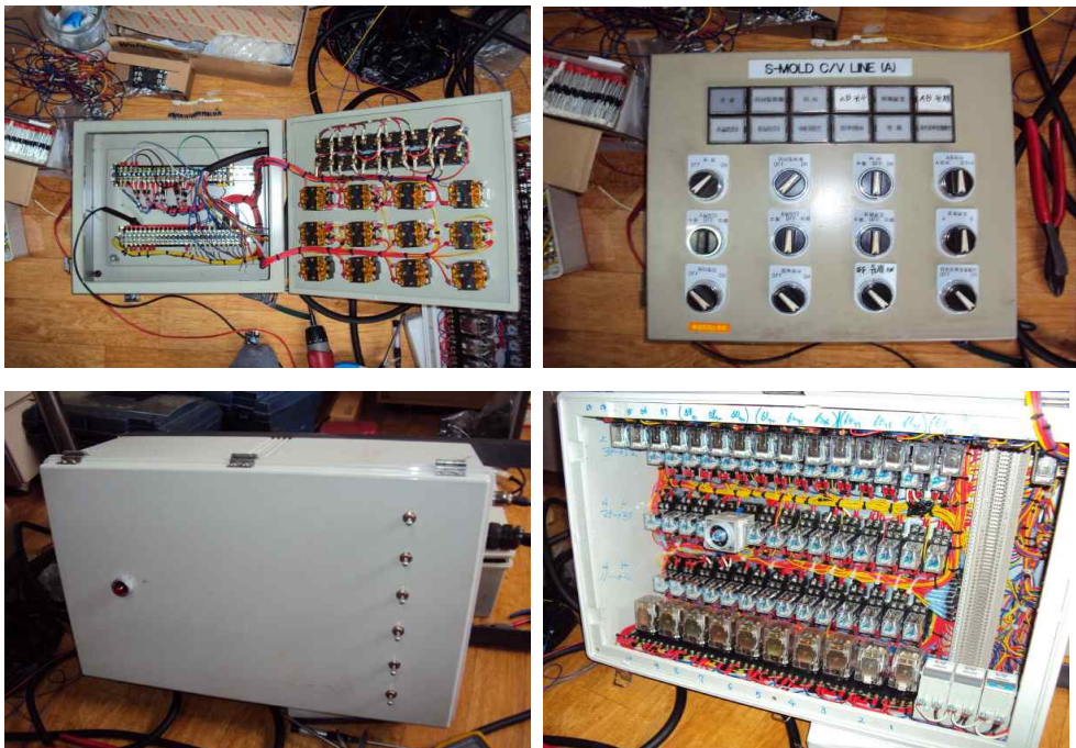
〈그림 3.10〉 장비 제어부 제작 및 배선
