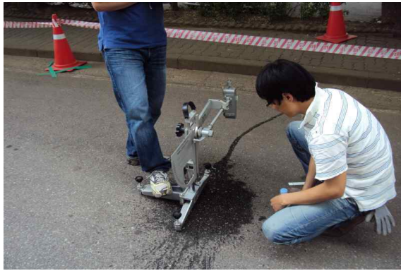
〈그림 3.98〉 시공 전(왼쪽)과 후(오른쪽)의 미끄럼 저항 측정시험
