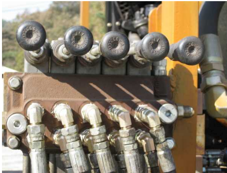
<그림 3.11> 장비 외부의 수동 조작 레버
