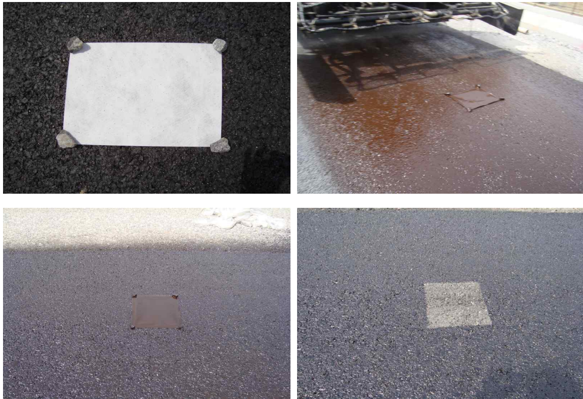
〈그림 3.85〉 살포량 측정을 위한 흡착포 시험
