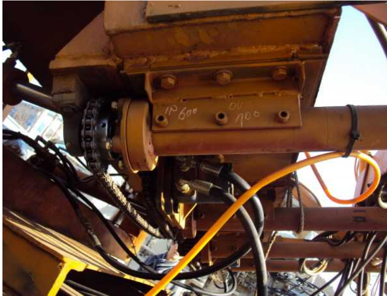
〈그림 3.34〉 오우거의 회전속도 조절을 위한 유압시스템
