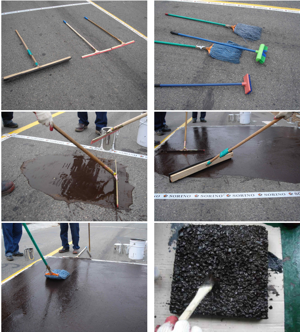
〈그림 3.42〉 스크리드 재료 선택을 위한 비교 시험
