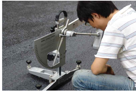
〈그림 3.98〉 시공 전(왼쪽)과 후(오른쪽)의 미끄럼 저항 측정시험
