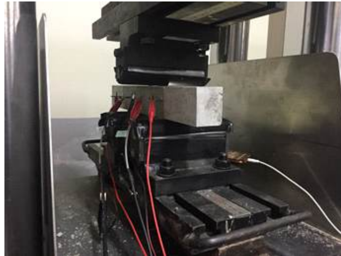
Fig. 70 실험실 규모의 휨 실험 과정
