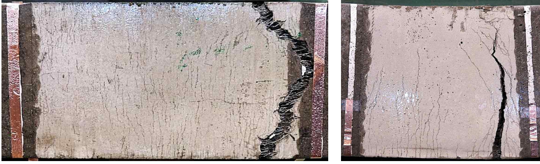
Fig. 34 - 자기감지 섬유보강 콘크리트를 타설한 철근콘크리트 빔의 미세균열 거동
