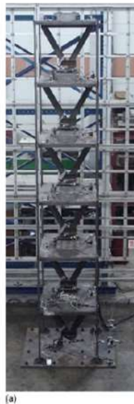
(a) 무선센서를 이용한 반능동 진동제어 실험
