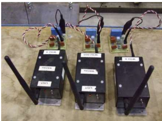
그림 7. 무선 케이블 장력계측 시스템
