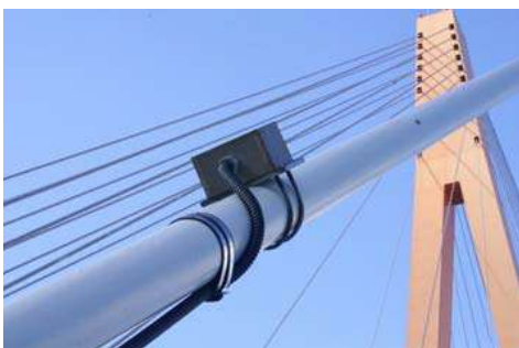
그림 6. 장대교량 케이블에 설치된 장력계측용 가속도계 (진도대교)
