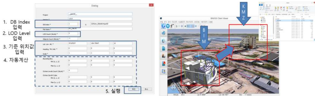
그림 III-23. BIM 데이터 절대좌표 변환 -1 그림 III-24. BIM 데이터 절대좌표 변환 -2
