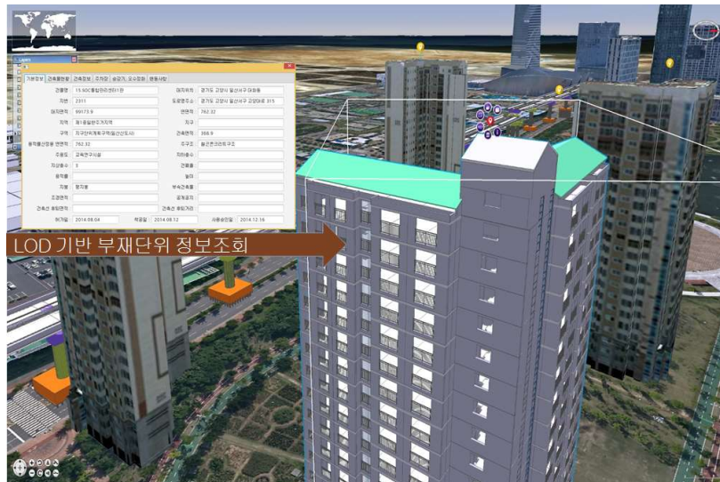
그림 III-3. 공간 및 속성 LOD 기반 부재단위 정보조회 기술
