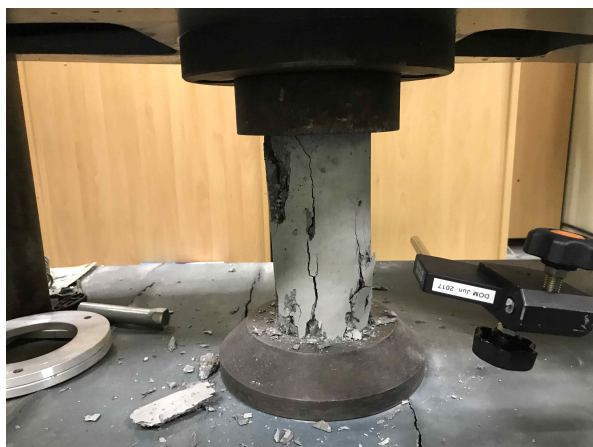
<압축하중 유지시험 수행을 위한 UTM 장비(1) 및 유지시험 후 파괴된 시험체>
