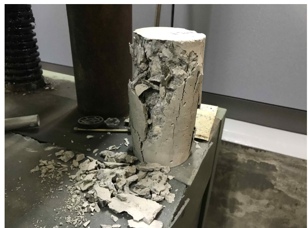
<압축하중 유지시험 수행을 위한 UTM 장비(1) 및 유지시험 후 파괴된 시험체>
