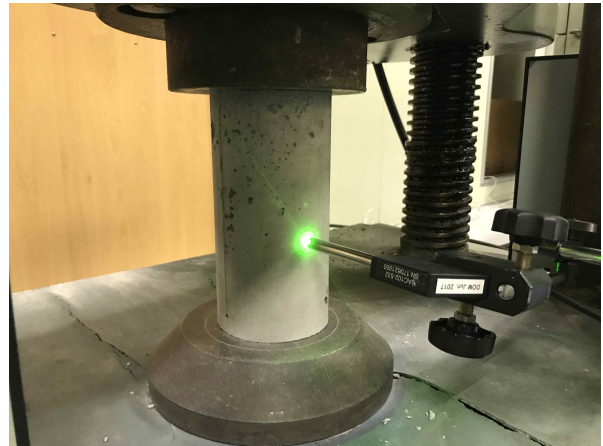
<UTM 장비1에 설치된 시편 및 레이저 조사 전경>
