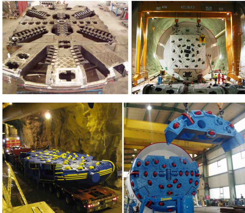
[그림 2.1.6] 현장으로의 운반과 조립을 위한 커터헤드의 대칭 분할(예)
