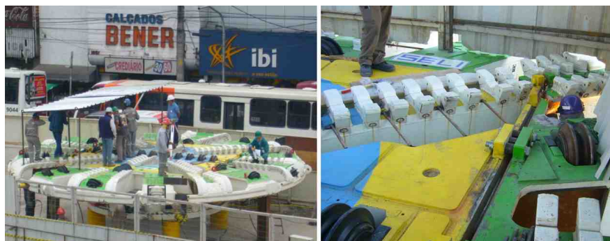
[그림 2.1.7] 현장에서의 커터헤드 보호작업 (좌: 용접을 위한 보호, 우: 나사조임)
