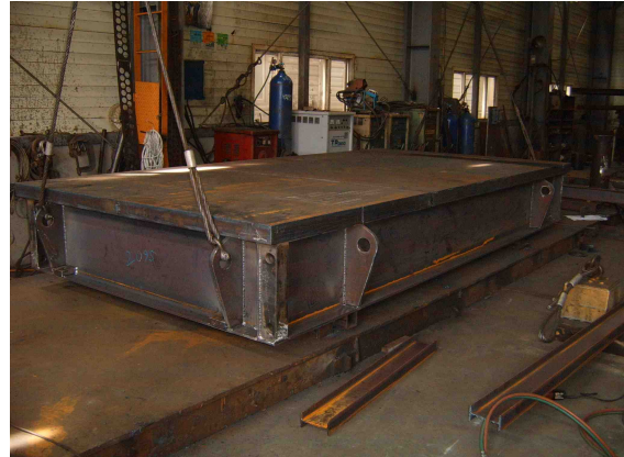
[그림 2.4.5] 커터헤드 제작용 부속설비 및 jig의 제작 과정
