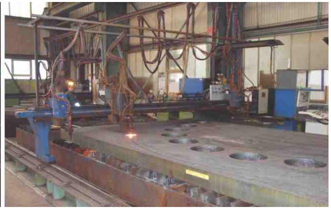
[그림 2.1.13] 원 강판의 가공을 위한 플라즈마 절단기(최대 220 mm)
