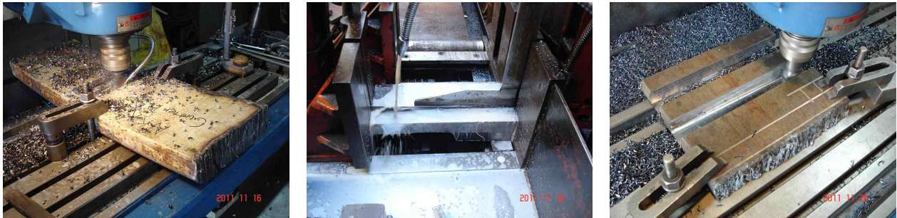
[그림 2.3.5] 시험편 제작을 위한 소재 절단 작업
