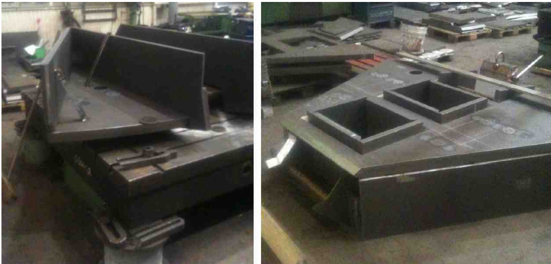
[그림 2.1.11] 재하조건에 따른 다양한 철판 두께(예) (보통 30~40 mm)
