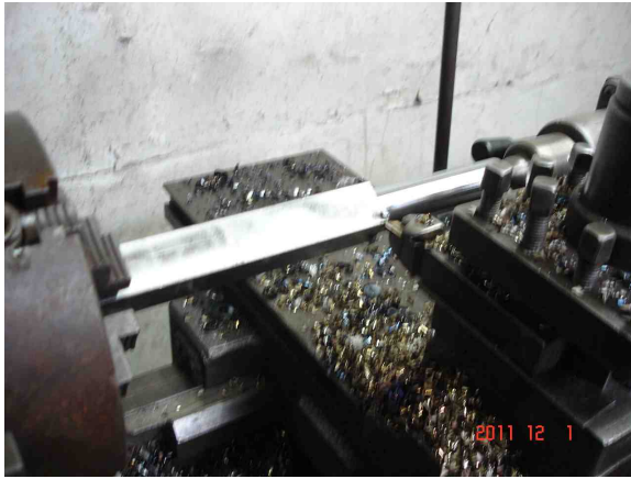
[그림 2.3.9] 시험편 가공 장면
