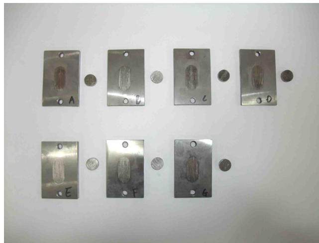
[그림 2.3.21] 마모시험 시험편(HARDOX 재질 - 왼쪽, 대상 시험편 - 오른쪽)
