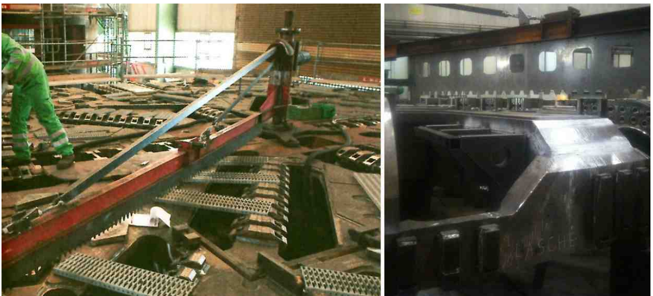
[그림 2.1.5] 커터 하우징의 정확한 설치·제어를 위한 형판의 설치(예)
