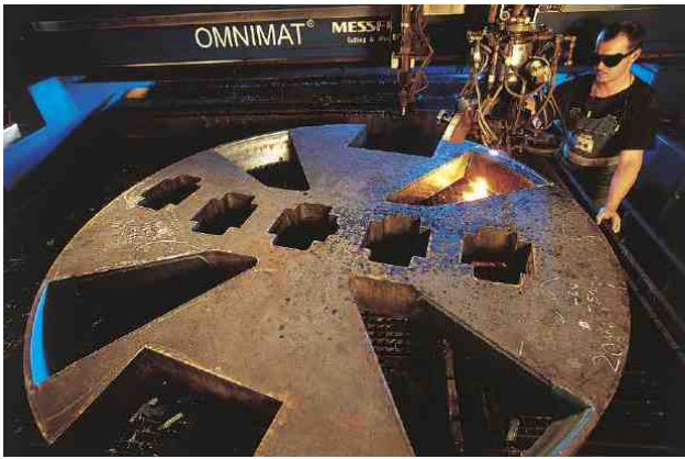
[그림 2.1.13] 원 강판의 가공을 위한 플라즈마 절단기(최대 220 mm)
