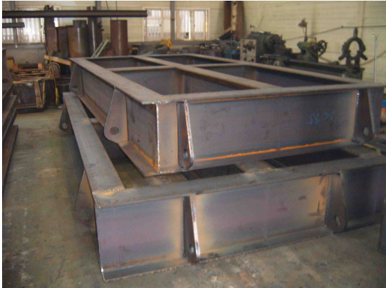
[그림 2.4.5] 커터헤드 제작용 부속설비 및 jig의 제작 과정
