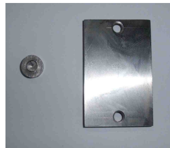
[그림 2.3.12] 마모시험 시험편
