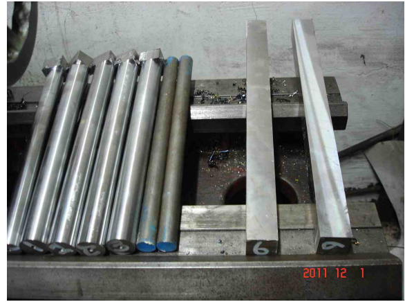
[그림 2.3.9] 시험편 가공 장면
