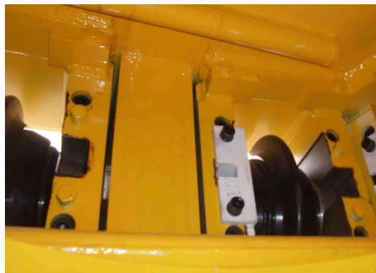
[그림 2.2.25] 디스크커터 홀더 사이에 설치된 사각박스
