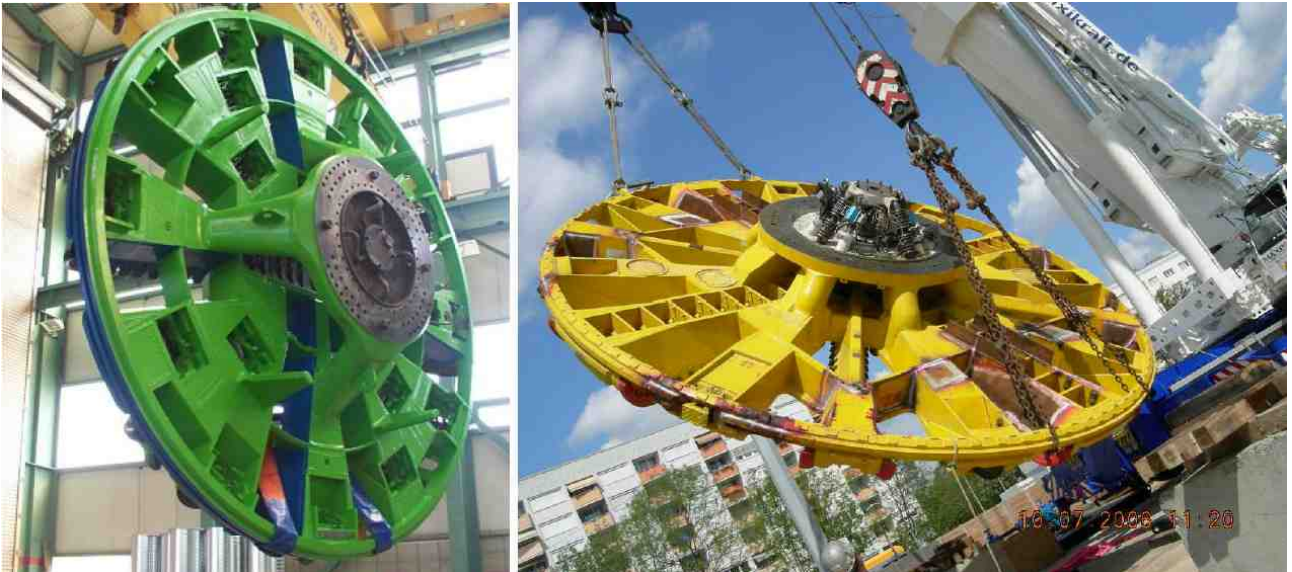
[그림 2.1.3] 복합지반용 커터헤드 arm의 개수(예) (좌: 5 m미만, 우: 5 m이상)
