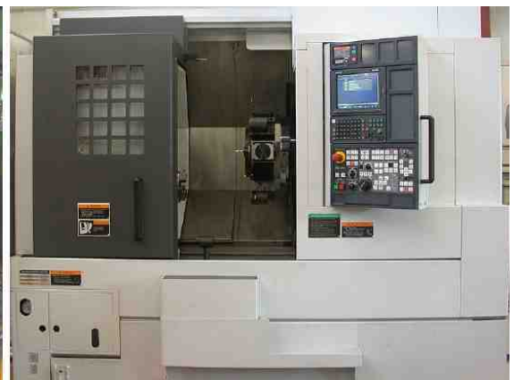
[그림 2.1.14] 밀링 장비에 의한 가공 작업(좌)과 CNC 공작기계(우)
