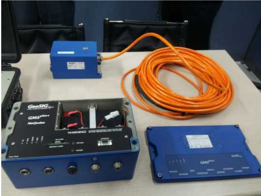
[기존 방식의 지진계 센서 모듈 및 data logger]
