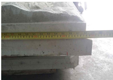
(1) 패널 길이 측정
