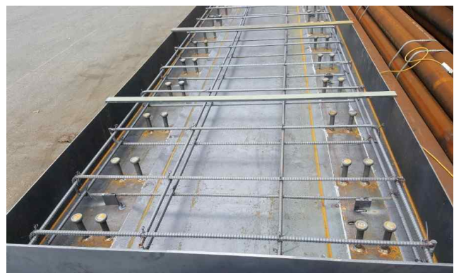
그림 4. 수평 절곡강판 거더 합성연결부 접합부 제작 사진
