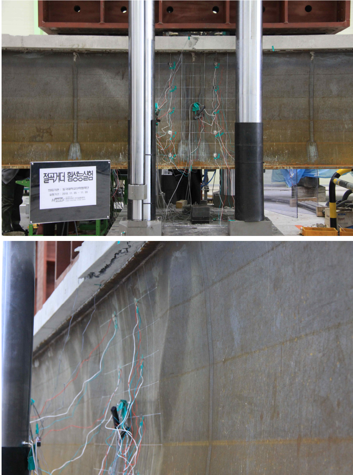
그림 17. 파괴 후 거더 복부판 형상
