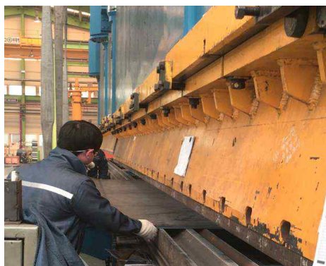
[Press-bending에 의한 강판의 절곡작업]
