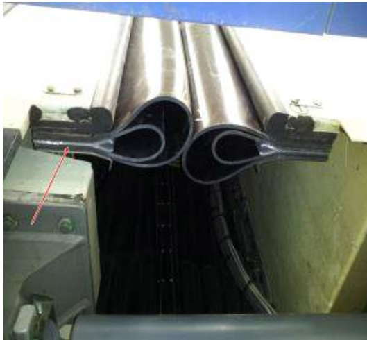
<싸이드 베리어 현차 설치 1(하부)>
