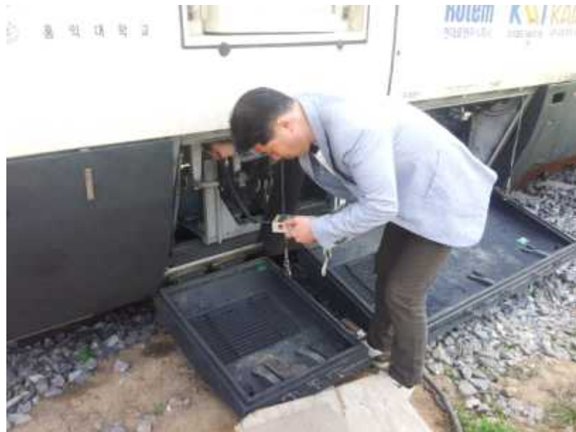
<공기압축기 현차 진동 측정>
