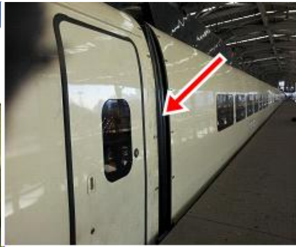
<싸이드 베리어 현차 설치 2(측면)>
