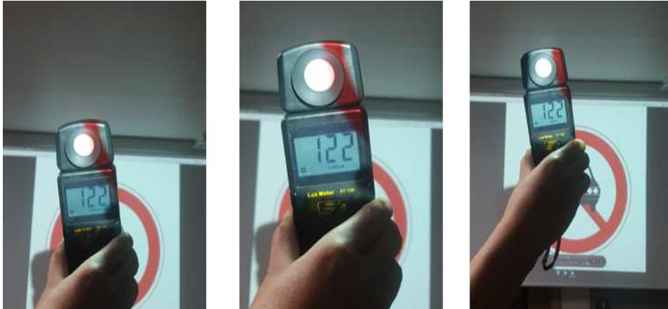
<도로바닥표시기 밝기(휘도) 측정>
