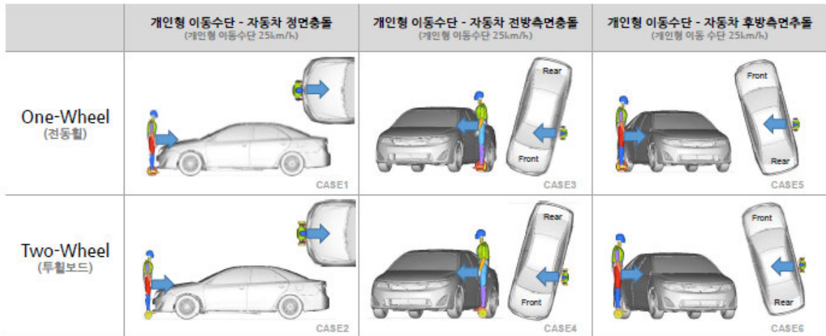
<그림 26> 개인형 이동수단-자동차 간의 충돌해석 시나리오
