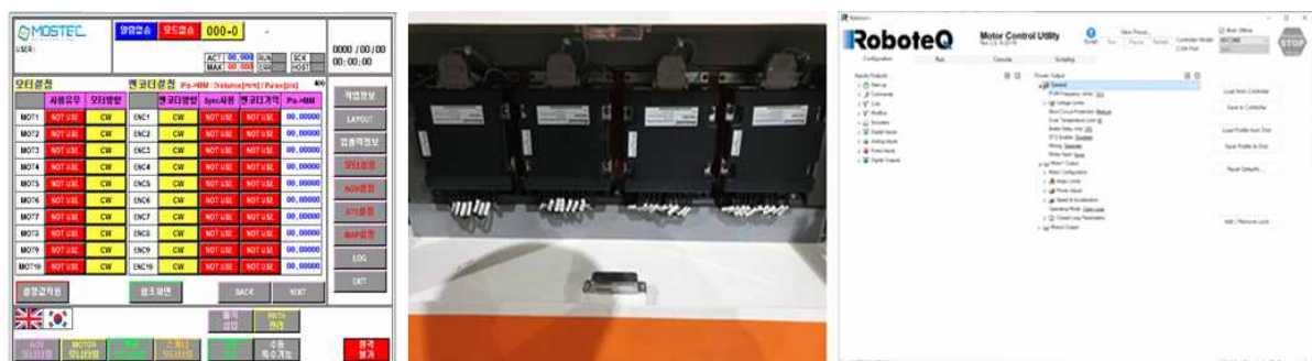
[그림 63] 지상 이송 지원 장치의 주행 모터 및 모터 설정 화면
