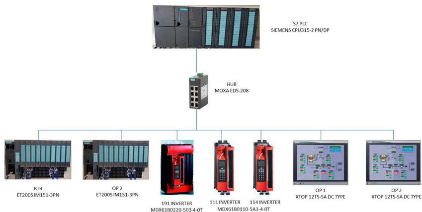
[그림 47] 수직이송체(화물이송 및 셔틀이송 리프트) 제어 구성도
